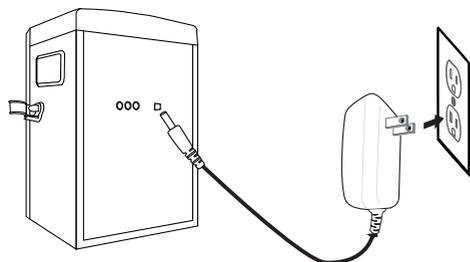
Insérez le cordon d'alimentation c.a. dans une prise c.a. située à proximité et dotée de 120 V c.a. et 60 Hz.
