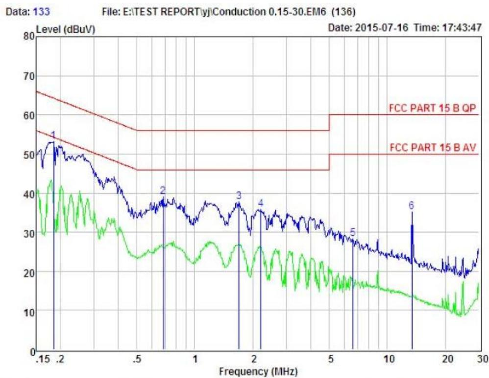
Condition : FCC PART 15 B QP      POL: LINE      Temp: 24 °C      Hum: 56 %
