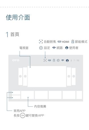
使用遙控器,選取 [+] 並按 🐼 鍵進行自動對焦,即可使影像 請使用 HDMI 線接入外部影音訊號裝置,使用遙控器,選 取 🗢 並按 🐼 鍵進行切換訊號來源,即可播放外部影音訊
