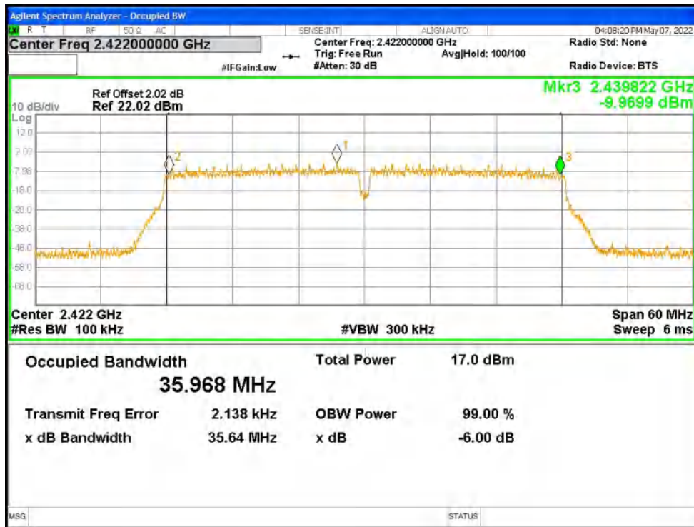
-6dB Bandwidth NVNT n40 2437MHz Ant1
