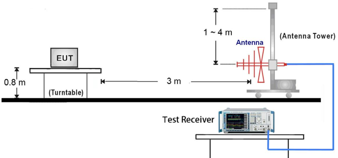
1GHz ~ 25GHz Test Setup:
