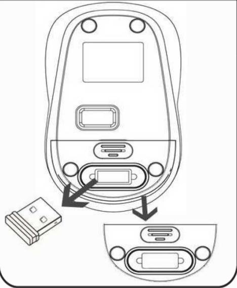
Plaats de batterijen zoals aangegeven, met de juiste polariteit. Haal eveneens de nano-receiver uit de muis. Placez les piles comme indiqué, dans le sens correct de la polarité. Retirez aussi le récepteur-nano de la souris.
