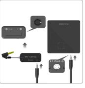
XCAL-Solo III와 MOS Kit, BT-Transceiver II를 연결 합니다.
