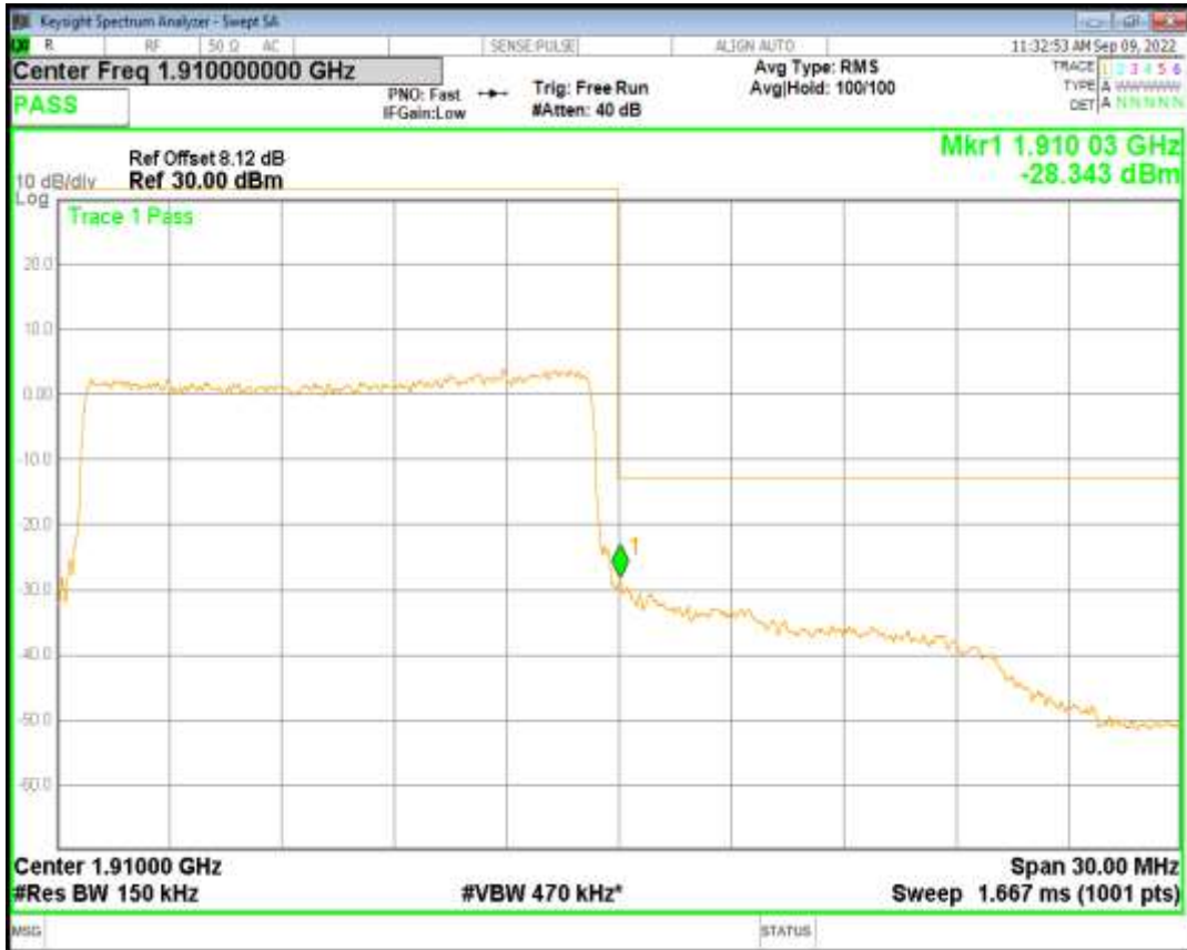
Band2 QPSK BW=20MHz Channel=18700 RB Size=100 Position=#0
