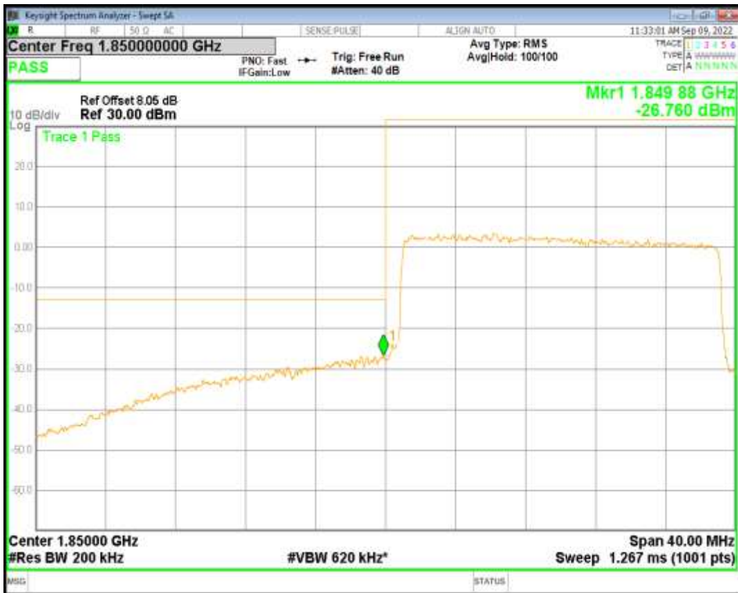
Band2 QPSK BW=20MHz Channel=19100 RB Size=100 Position=#0
