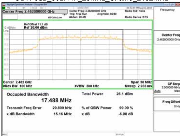
OBW 6dB 802.11n 20MHz Chain0 2462MHz
