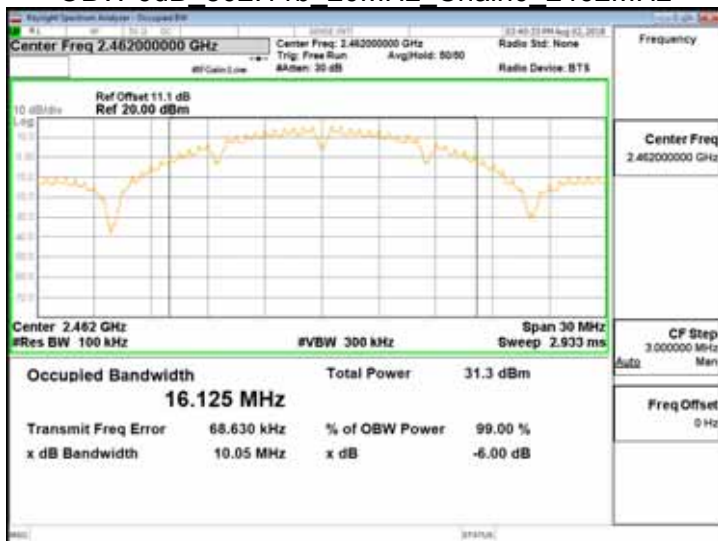
OBW 6dB 802.11b 20MHz Chain0 2462MHz
