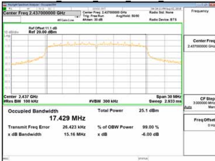
OBW 6dB 802.11n 20MHz Chain0 2462MHz
