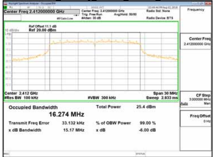
OBW 6dB 802.11g 20MHz Chain0 2437MHz
