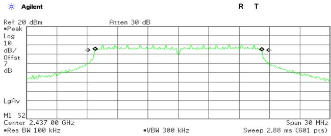
Occupied Bandwidth 16.4522 MHz Осс ВМ % Рыг 99.00 % ж dB -6.00 dB
