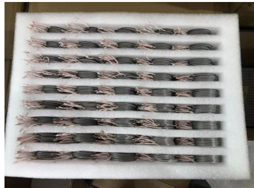
图 2: 统一方向线头朝上整齐排放入盘中
