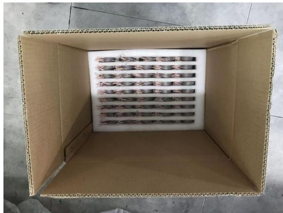
图 3: 放入包装箱, 每箱放置 4 层
