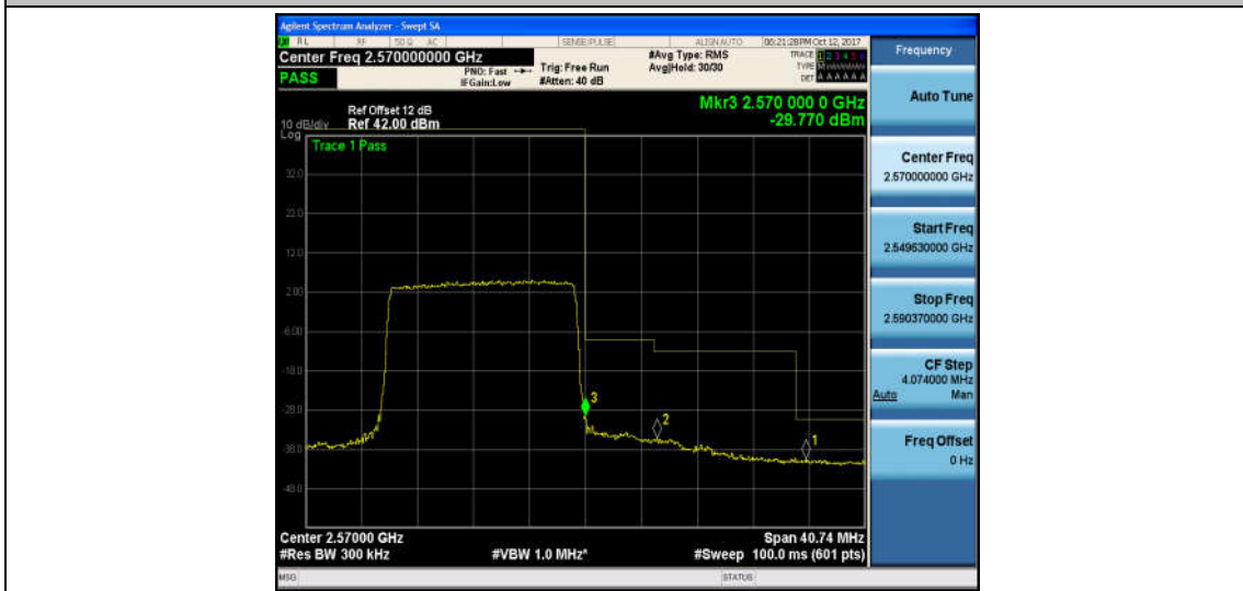
Band7_20MHz_QPSK_20850_1RB#0_-36.03,-35.08,-17.80_PASS
