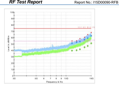
Fig.48 Radiated emission:  $\pi/4$  DQPSK, Ch0, 3GHz~18GHz
