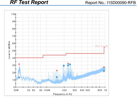
Fig.46 Radiated emission:  $\pi/4$  DQPSK, Ch0, 30MHz~1GHz
