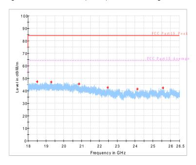
Fig.51 Radiated emission: π/4 DQPSK, 18 GHz - 26 GHz
