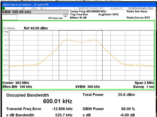
Test Sample: LC-Q2 FCC ID: 2AA9N-LCQ2
