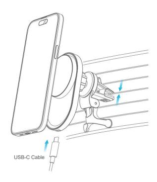
**4.**將另一端 Type-C 充電線連接您車上的 Type-C 充電口或是車載充電器 (需將車載充電器置入汽車點煙器 孔位内。)
