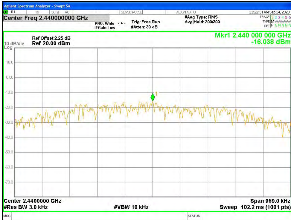
PSD NVNT BLE 1M 2440MHz Ant3
