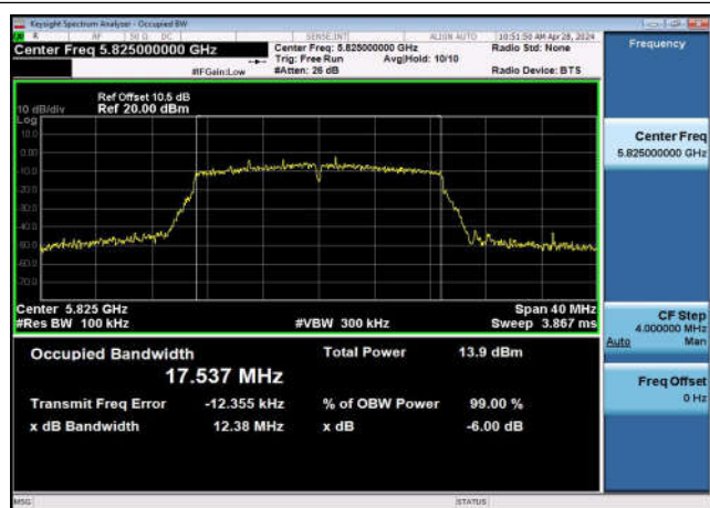
U-NII-3 6dB Bandwidth-802.11ac(20MHz) ,5825MHz,Ant1
