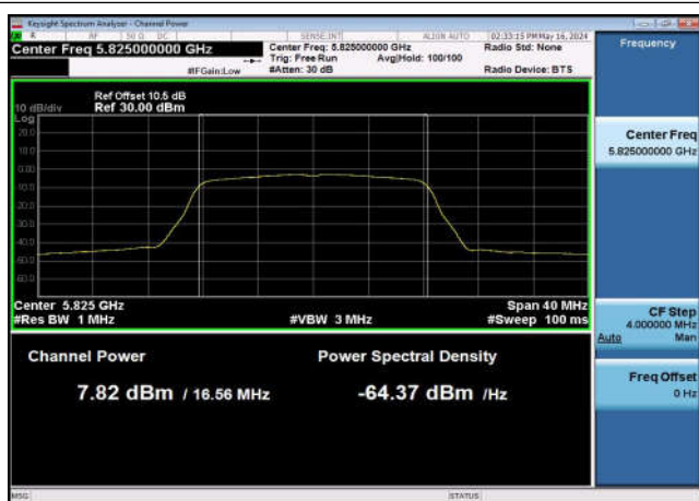
U-NII-3 Output Power-802.11ac(20MHz) ,5785MHz,Ant1
