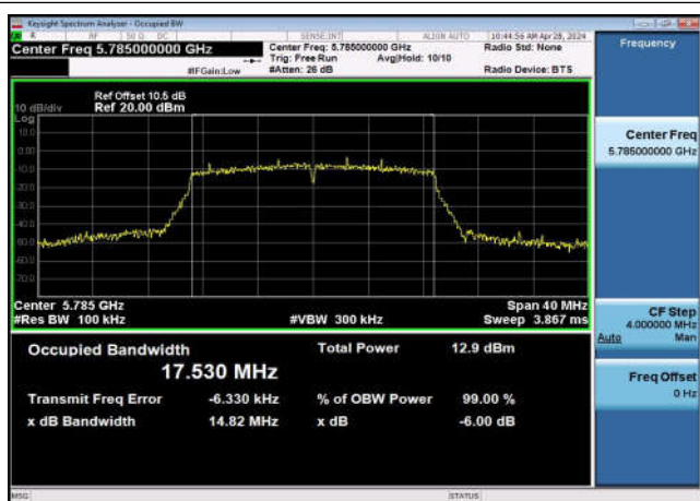
U-NII-3 6dB Bandwidth-802.11ac(40MHz) ,5755MHz,Ant1
