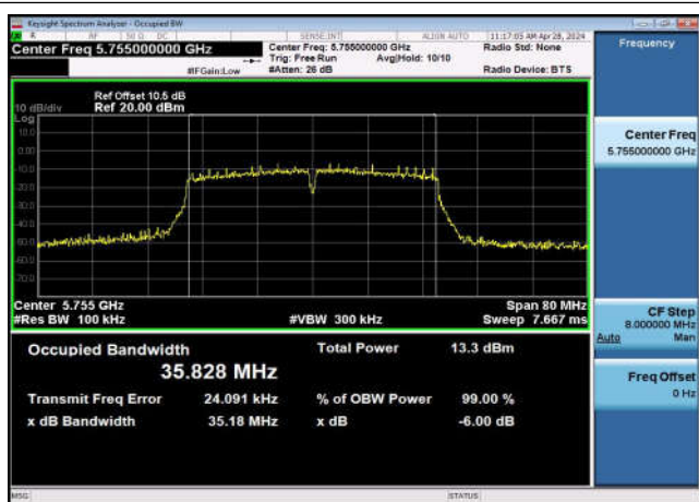
U-NII-3 6dB Bandwidth-802.11ac(40MHz) ,5755MHz,Ant1
