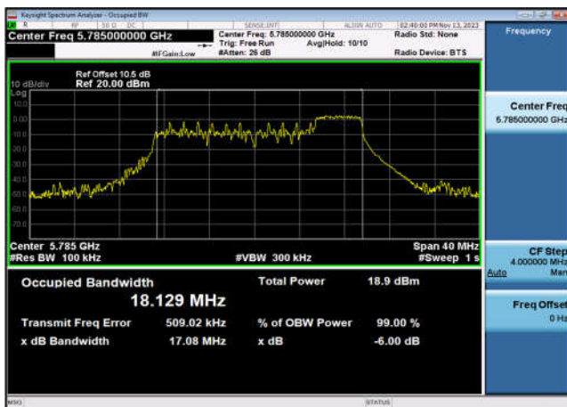
U-NII-3 6dB Bandwidth-802.11ax(20MHz _RU52_4),5825MHz,Ant7
