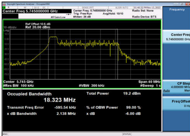
U-NII-3 6dB Bandwidth-802.11ax(20MHz _RU26_1),5785MHz,Ant7
