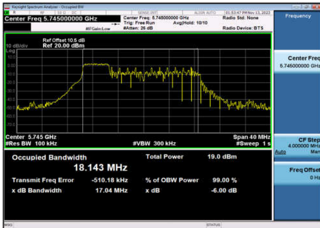
U-NII-3 6dB Bandwidth-802.11ax(20MHz _RU52_1),5785MHz,Ant7
