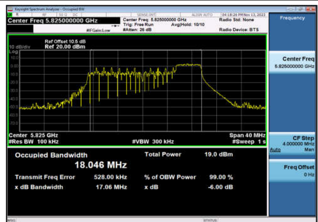
U-NII-3 6dB Bandwidth-802.11ax(20MHz _RU52_4),5825MHz,Ant6
