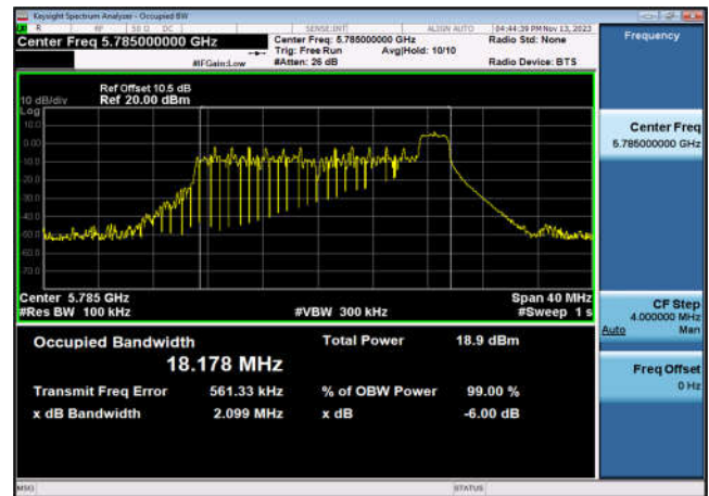
U-NII-3 6dB Bandwidth-802.11ax(20MHz _RU26_9),5825MHz,Ant6
