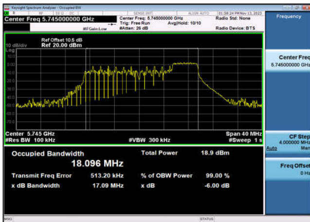
U-NII-3 6dB Bandwidth-802.11ax(20MHz _RU52_4),5785MHz,Ant7
