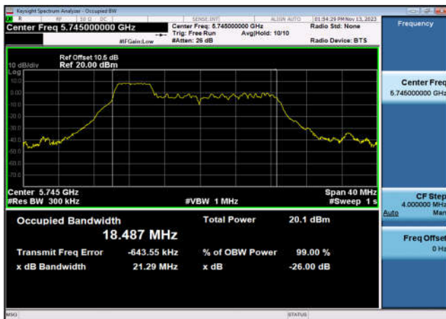
U-NII-3 99% OBW&26 dB EBW-802.11ax(20MHz _RU52_1),5785MHz,Ant7
