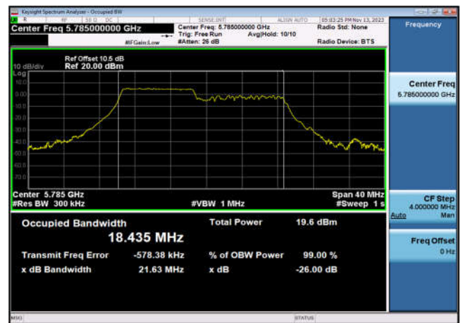
U-NII-3 99% OBW&26 dB EBW-802.11ax(20MHz _RU106_1),5825MHz,Ant6
