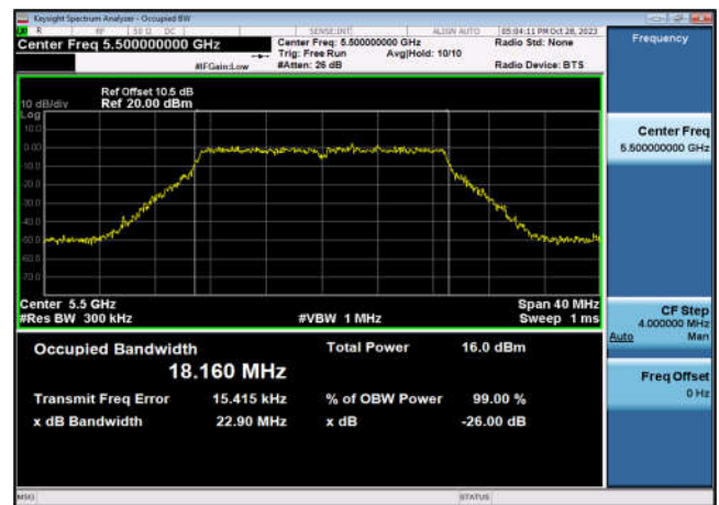
U-NII-2c 99% OBW&26 dB EBW-802.11ac(20MHz),5600MHz,Ant6
