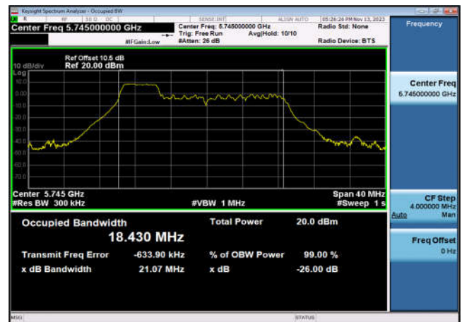
U-NII-3 99% OBW&26 dB EBW-802.11ax(20MHz _RU52_1),5785MHz,Ant6
