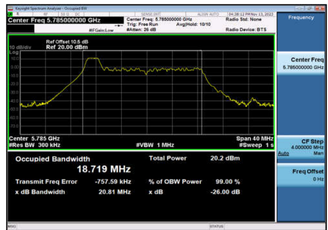
U-NII-3 99% OBW&26 dB EBW-802.11ax(20MHz _RU26_1),5825MHz,Ant6
