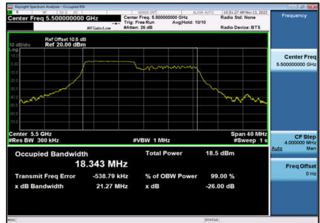
U-NII-2c 99% OBW&26 dB EBW-802.11ax(20MHz _RU106_1),5600MHz,Ant6
