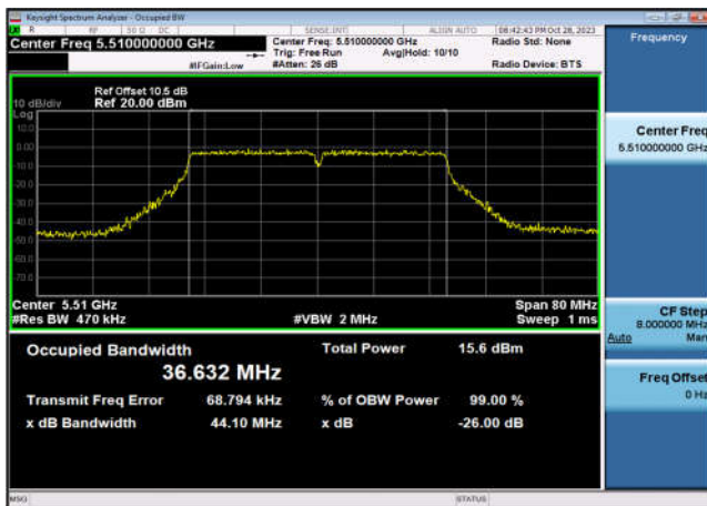
U-NII-2c 99% OBW&26 dB EBW-802.11n(40MHz) ,5590MHz,Ant7
