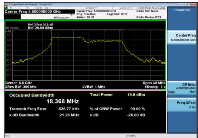
U-NII-2c 99% OBW&26 dB EBW-802.11ax(20MHz _RU106_1),5700MHz,Ant6
