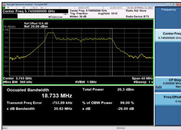
U-NII-3 99% OBW&26 dB EBW-802.11ax(20MHz _RU26_1),5785MHz,Ant7
