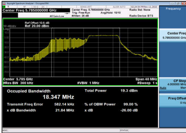
U-NII-3 99% OBW&26 dB EBW-802.11ax(20MHz _RU106_2),5825MHz,Ant7
