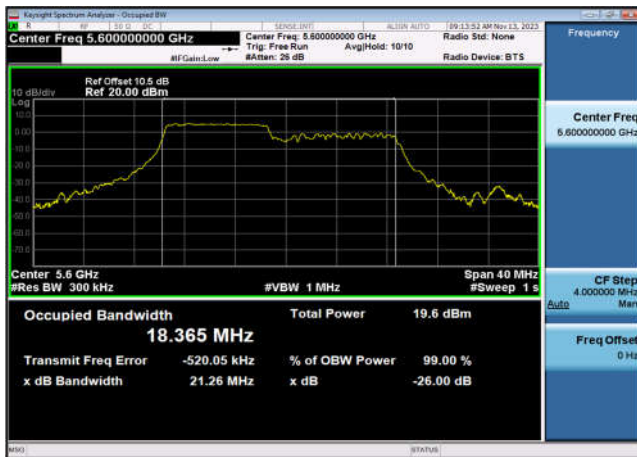
U-NII-2c 99% OBW&26 dB EBW-802.11ax(20MHz _RU106_1),5700MHz,Ant7
