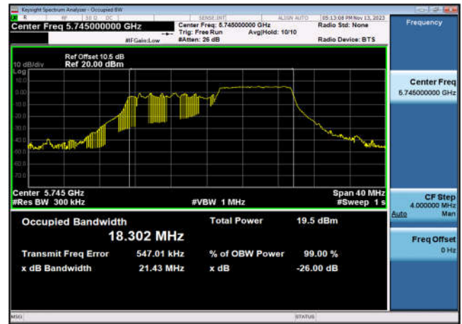
U-NII-3 99% OBW&26 dB EBW-802.11ax(20MHz _RU106_2),5785MHz,Ant6
