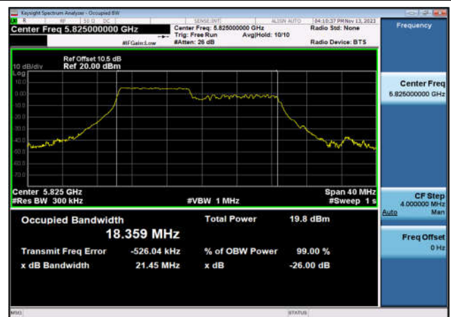
U-NII-3 99% OBW&26 dB EBW-802.11ax(20MHz _RU106_1),5825MHz,Ant6
