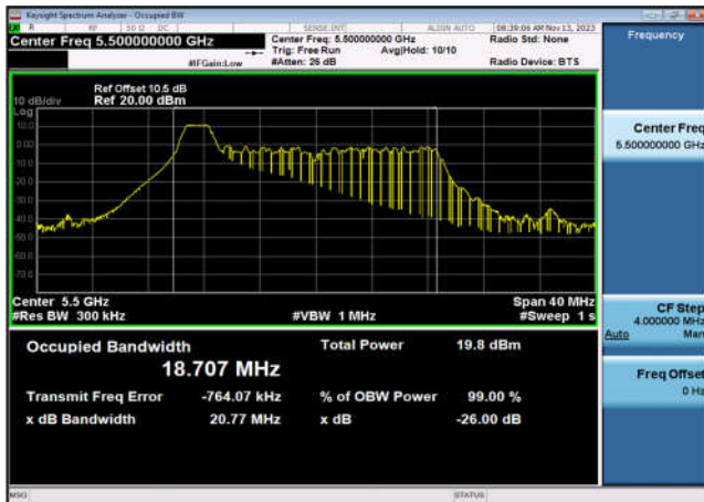
U-NII-2c 99% OBW&26 dB EBW-802.11ax(20MHz _RU26_1),5600MHz,Ant7
