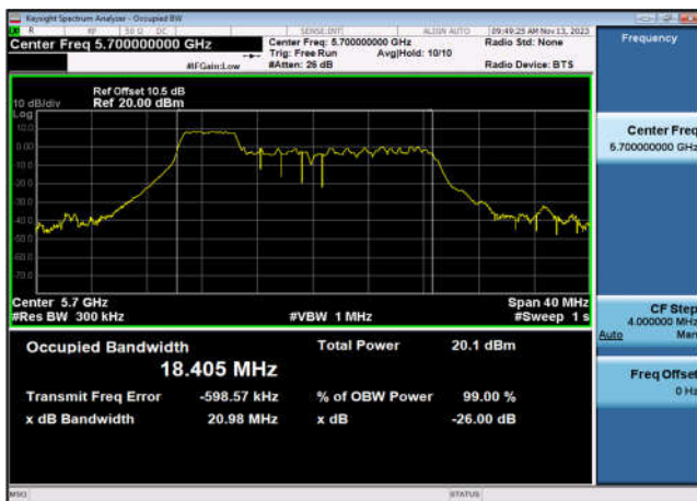
U-NII-2c 99% OBW&26 dB EBW-802.11ax(20MHz _RU52_1),5700MHz,Ant7
