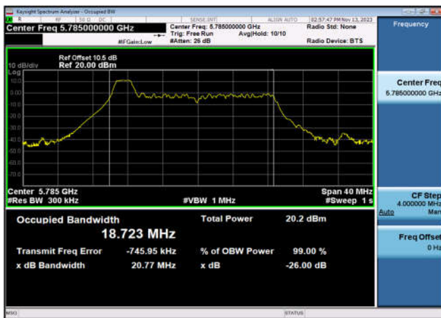
U-NII-3 99% OBW&26 dB EBW-802.11ax(20MHz _RU26_1),5825MHz,Ant7
