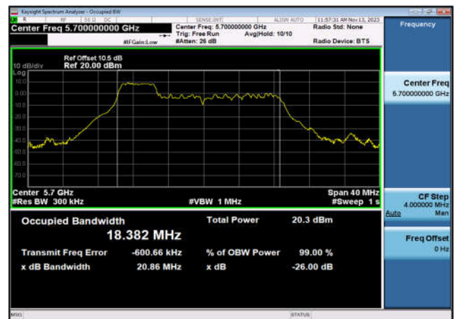
U-NII-2c 99% OBW&26 dB EBW-802.11ax(20MHz _RU52_1),5700MHz,Ant6
