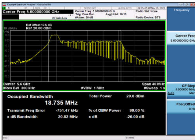
U-NII-2c 99% OBW&26 dB EBW-802.11ax(20MHz _RU26_1),5700MHz,Ant7
