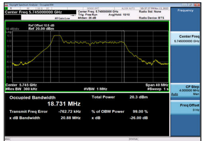
U-NII-3 99% OBW&26 dB EBW-802.11ax(20MHz _RU26_1),5785MHz,Ant6
