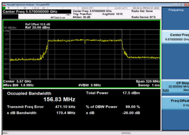
U-NII-2c 99% OBW&amp;26 dB EBW-802.11ax(20MHz),5500MHz,Ant7
