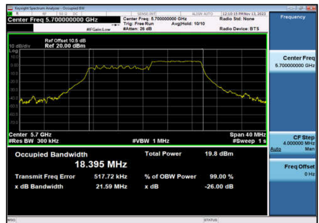
U-NII-2c 99% OBW&26 dB EBW-802.11ax(20MHz _RU106_2),5700MHz,Ant6
