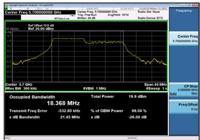
U-NII-2c 99% OBW&26 dB EBW-802.11ax(20MHz _RU106_1),5700MHz,Ant6
