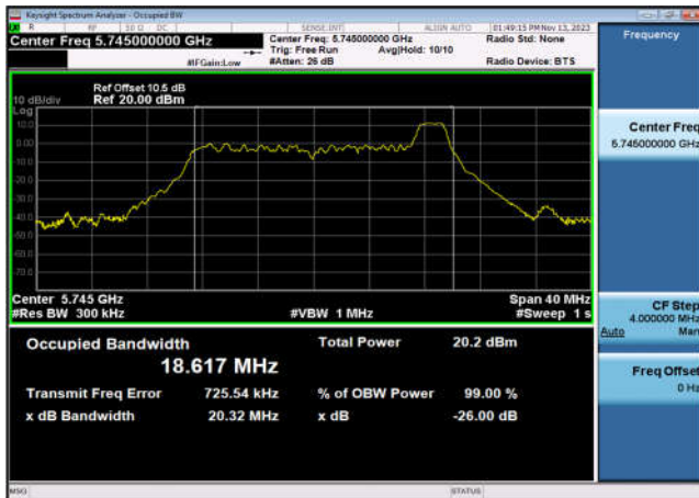
U-NII-3 99% OBW&26 dB EBW-802.11ax(20MHz _RU26_9),5785MHz,Ant7
