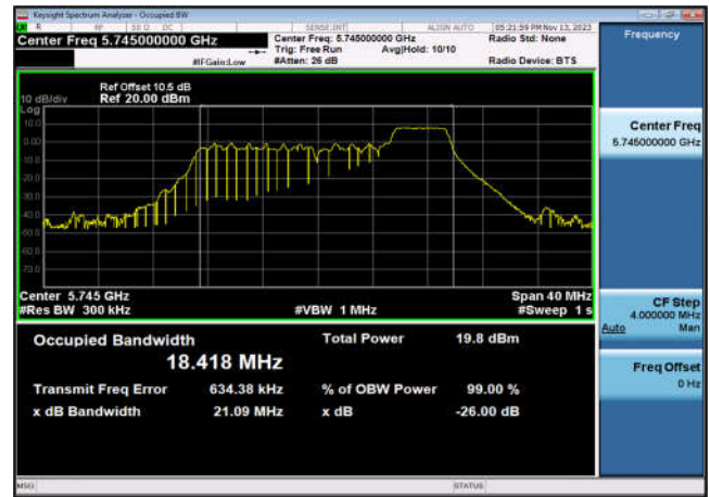
U-NII-3 99% OBW&26 dB EBW-802.11ax(20MHz _RU52_4),5785MHz,Ant6
