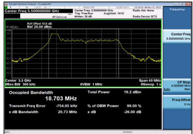
U-NII-2c 99% OBW&26 dB EBW-802.11ax(20MHz _RU26_1),5600MHz,Ant6
