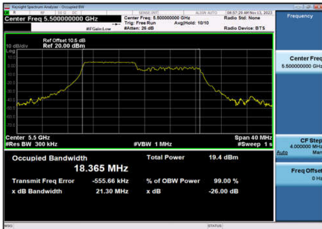
U-NII-2c 99% OBW&26 dB EBW-802.11ax(20MHz _RU106_1),5600MHz,Ant7
