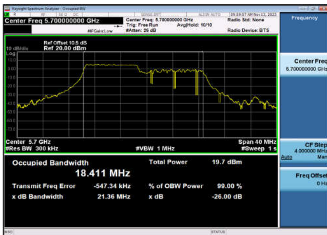
U-NII-2c 99% OBW&26 dB EBW-802.11ax(20MHz _RU106_1),5700MHz,Ant7
