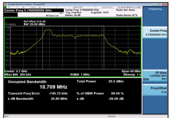
U-NII-2c 99% OBW&26 dB EBW-802.11ax(20MHz _RU26_1),5700MHz,Ant6
