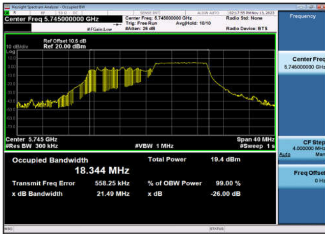
U-NII-3 99% OBW&26 dB EBW-802.11ax(20MHz _RU106_2),5785MHz,Ant7
