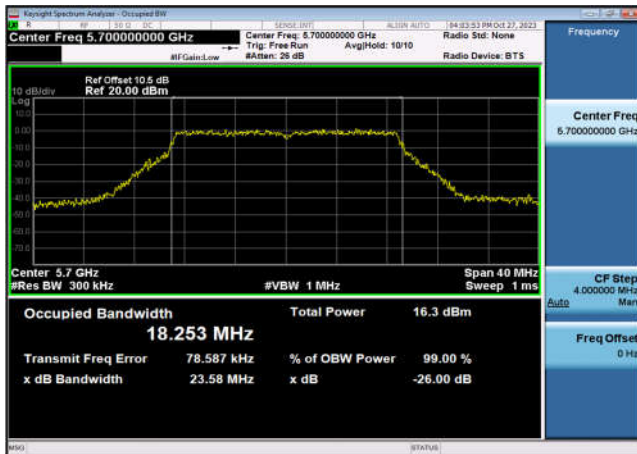
U-NII-2c 99% OBW&26 dB EBW-802.11ac(40MHz),5510MHz,Ant7
