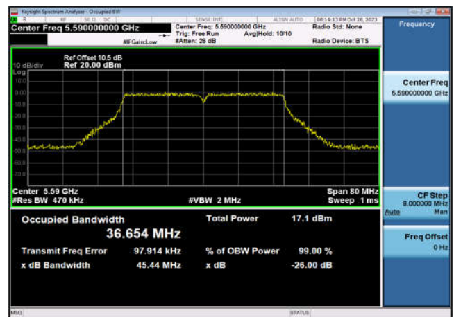
U-NII-2c 99% OBW&26 dB EBW-802.11ac(40MHz),5590MHz,Ant6
