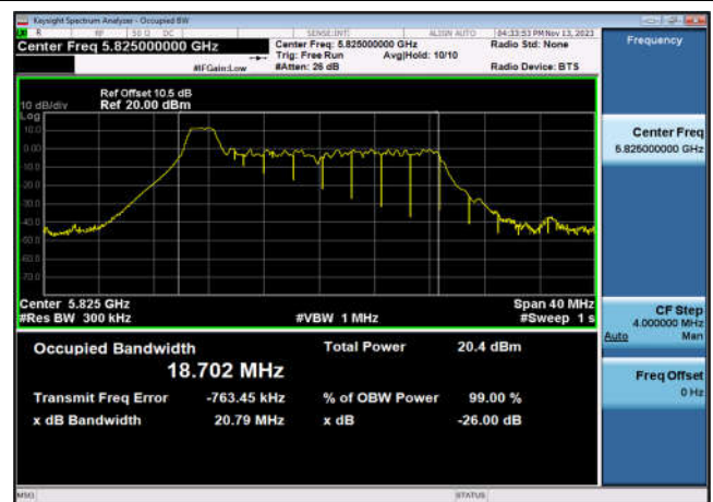
U-NII-3 99% OBW&26 dB EBW-802.11ax(20MHz _RU26_1),5825MHz,Ant6
