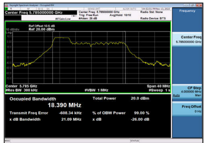
U-NII-3 99% OBW&26 dB EBW-802.11ax(20MHz _RU52_1),5825MHz,Ant6
