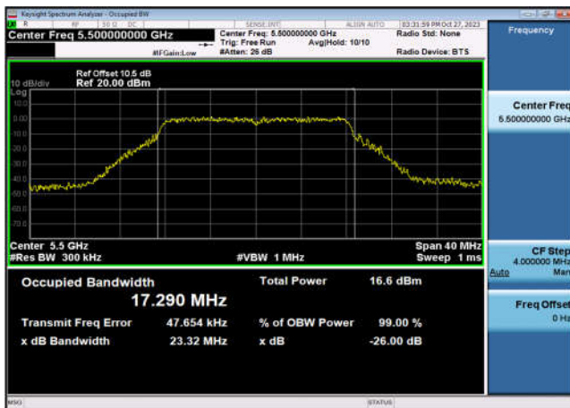
U-NII-2c 99% OBW&26 dB EBW-802.11a(20MHz) ,5600MHz,Ant7
