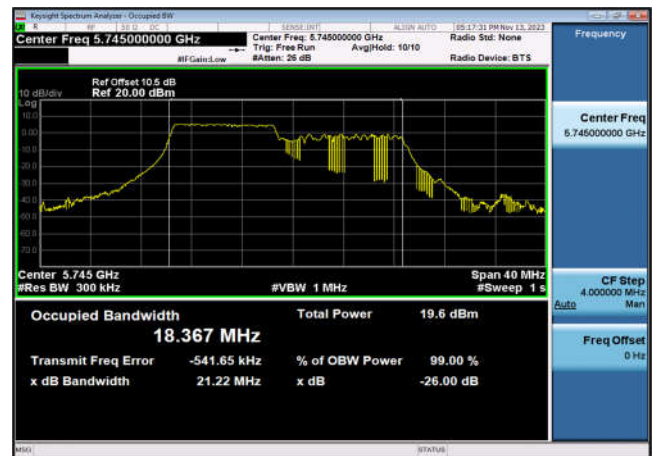
U-NII-3 99% OBW&26 dB EBW-802.11ax(20MHz _RU106_1),5785MHz,Ant6
