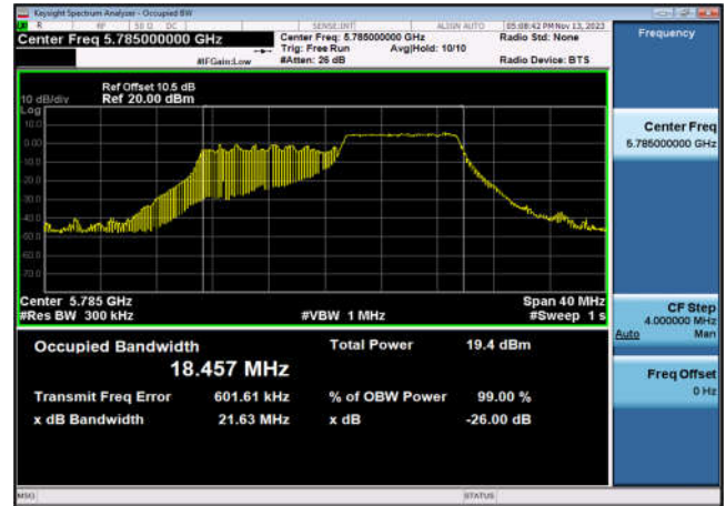
U-NII-3 99% OBW&26 dB EBW-802.11ax(20MHz _RU106_2),5825MHz,Ant6
