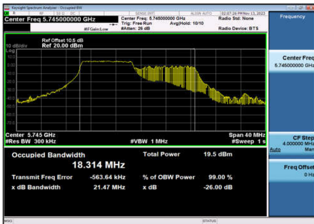
U-NII-3 99% OBW&26 dB EBW-802.11ax(20MHz _RU106_1),5785MHz,Ant7
