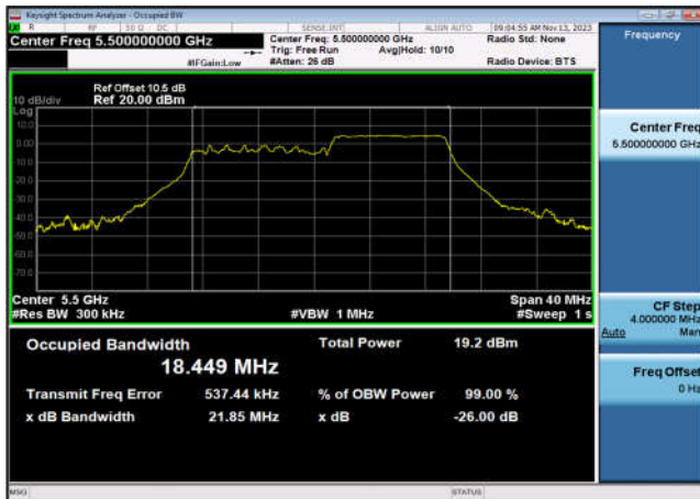
U-NII-2c 99% OBW&26 dB EBW-802.11ax(20MHz _RU106_2),5600MHz,Ant7
