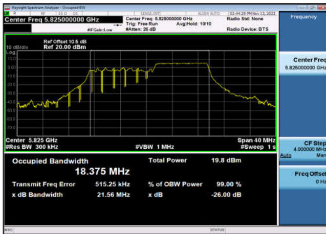
U-NII-3 99% OBW&26 dB EBW-802.11ax(20MHz _RU106_2),5825MHz,Ant7
