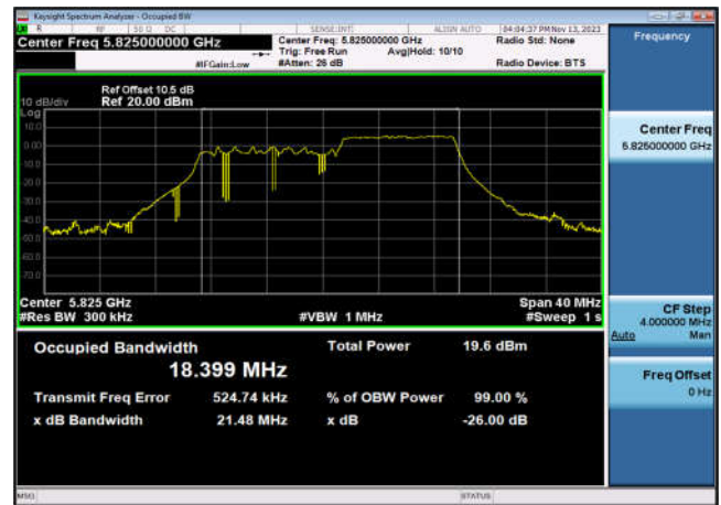
U-NII-3 99% OBW&26 dB EBW-802.11ax(20MHz _RU106_2),5825MHz,Ant6
