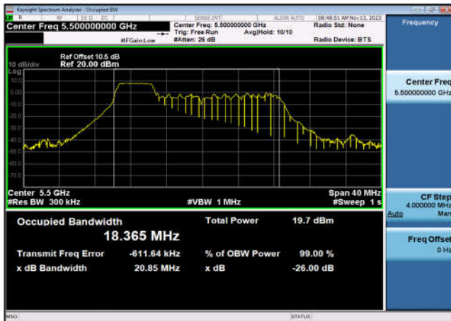
U-NII-2c 99% OBW&26 dB EBW-802.11ax(20MHz _RU52_1),5600MHz,Ant7
