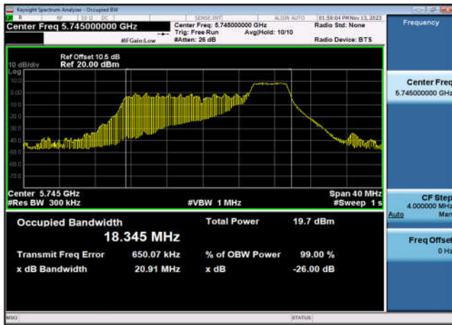
U-NII-3 99% OBW&26 dB EBW-802.11ax(20MHz _RU52_4),5785MHz,Ant7
