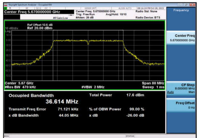
U-NII-2c 99% OBW&26 dB EBW-802.11ac(80MHz ,5530MHz,Ant6
