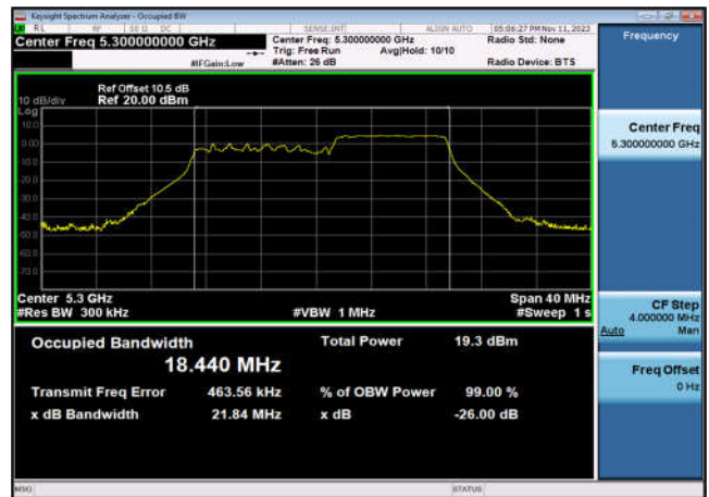
U-NII-2a 99% OBW&26 dB EBW-802.11ax(20MHz _RU106_2),5320MHz,Ant6
