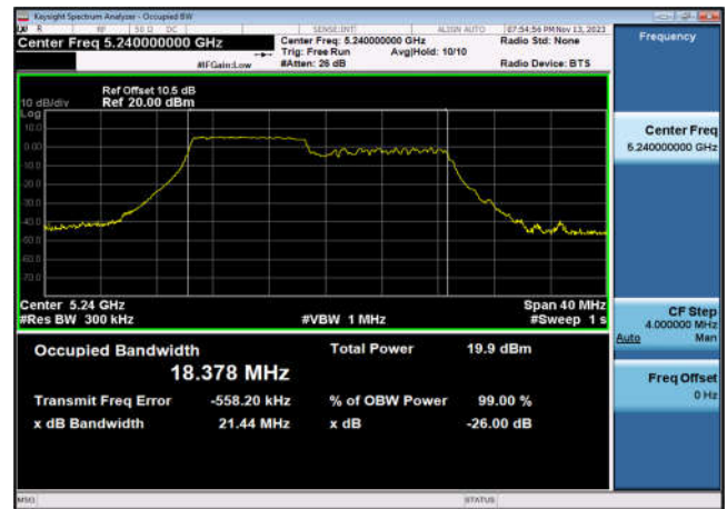
U-NII-1 99% OBW&26 dB EBW-802.11ax(20MHz _RU106_1),5240MHz,Ant6
