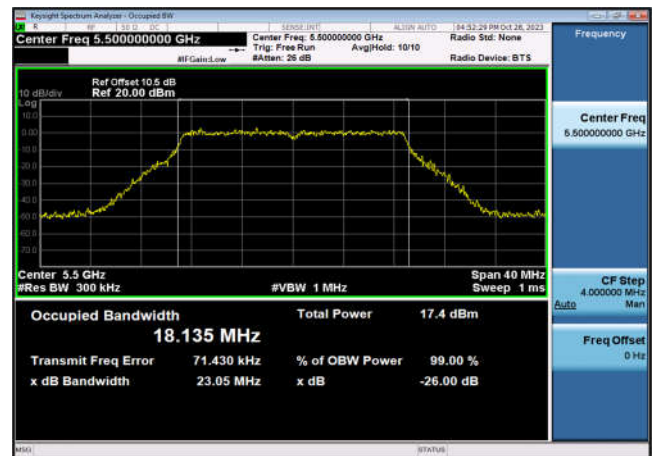
U-NII-2c 99% OBW&26 dB EBW-802.11n(20MHz) ,5600MHz,Ant6
