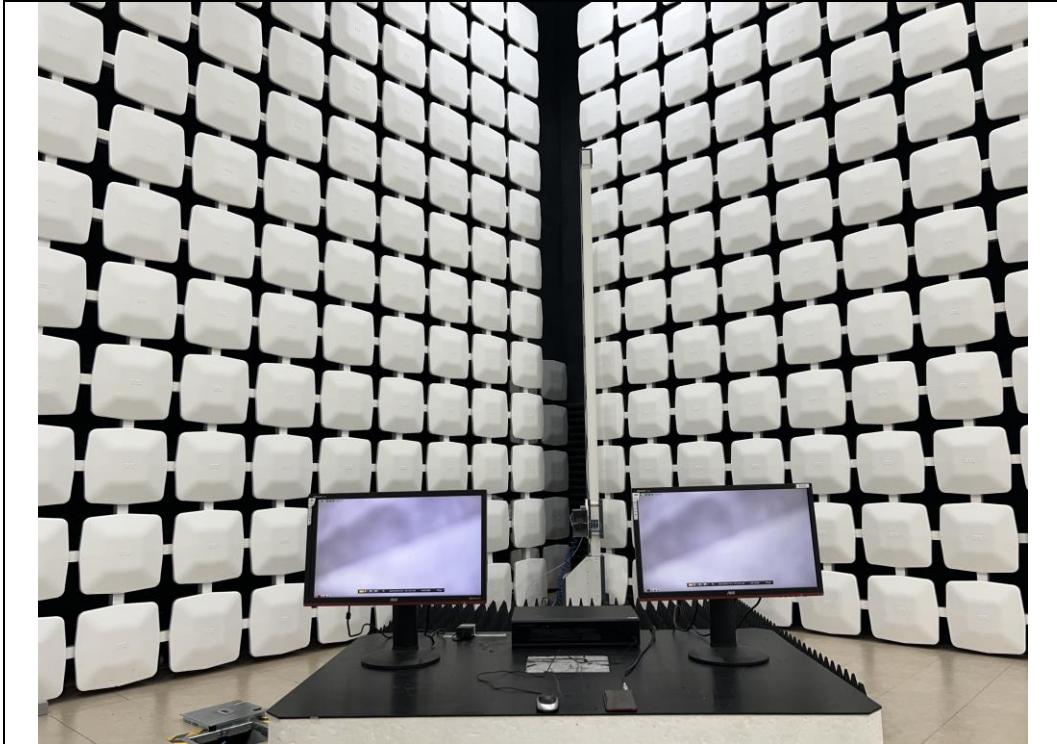
Test distance : 3 m, height of table : 0.8 m
