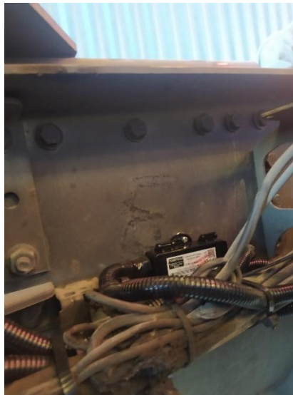
Figure 2: Répéteur 434 MHz installé sur le châssis du véhicule
