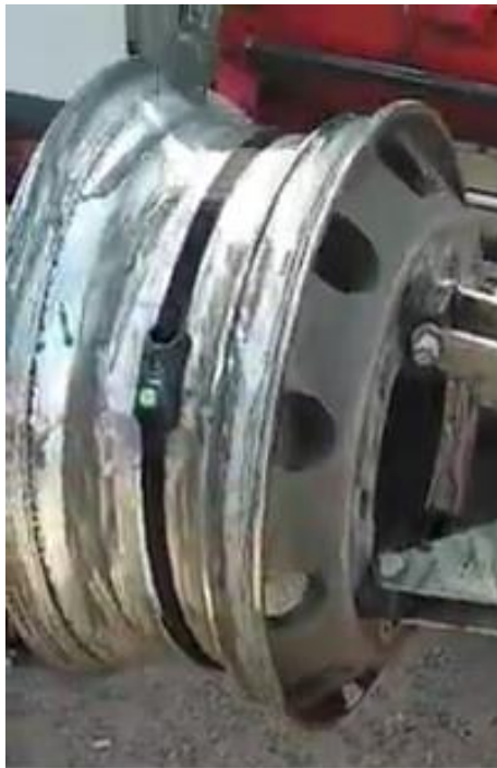
Figure 1: Transmetteur 434 MHz TPMS fixé sur une jante de véhicule
