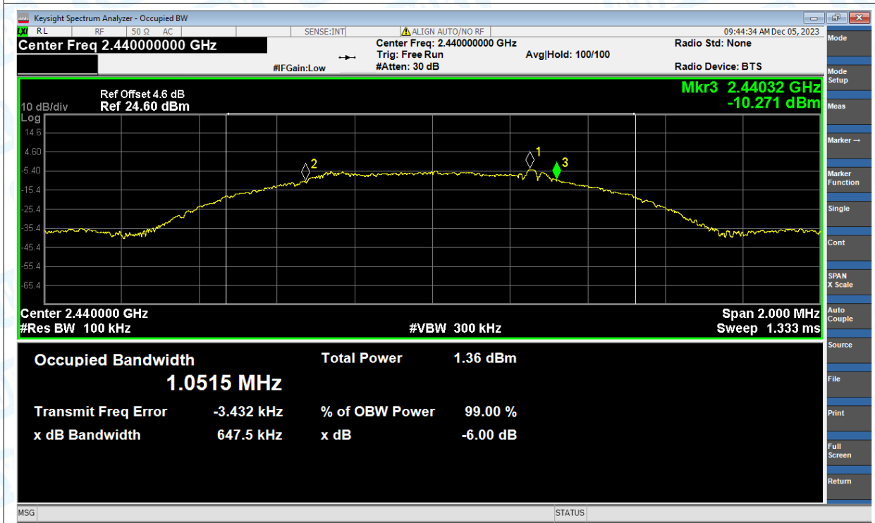
-6dB Bandwidth NVNT BLE 1Mbps 2440MHz Ant1
