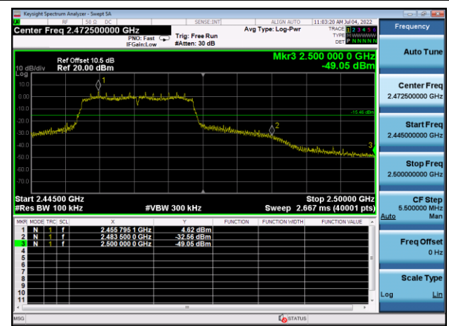
,Plot 2,Band Edge-802.11n(HT20) ,2462MHz,Ant0
