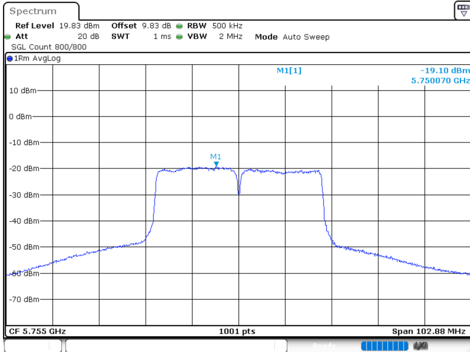
PSD NVNT 802.11n(HT40) 5755MHz Ant1
