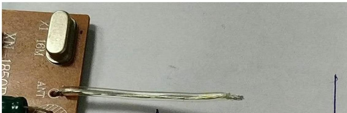
备注：2.4G 天线规格为 19 芯外径 1.35MM 镀锡铜丝导线，透明色，长度为 35MM,线头剥皮 3MM 上锡。符合环保标准： 欧盟 EN71(19E)、ROHS、PAHS、6P~16P、欧美 CPSIA、HR4040。
