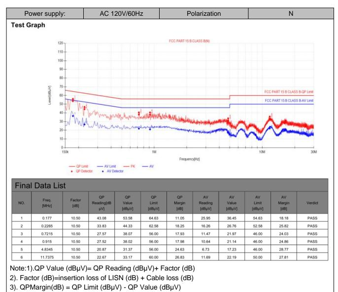
4). AVMargin(dB) = AV Limit (dB $\mu$ V) - AV Value (dB $\mu$ V)
