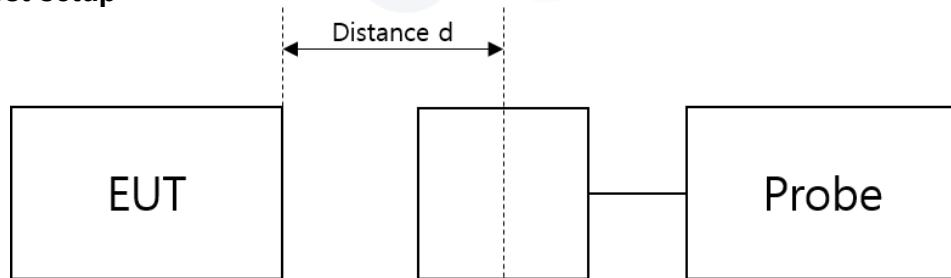
H-Field Probe : Narda EHP-200A Probe 92 cm<sup>2</sup> (3cm<sup>2</sup> for d < 6 cm)
