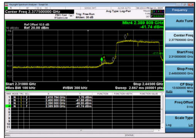
,Plot 2,Band Edge-802.11ax(40MHz) ,2437MHz,Ant12
