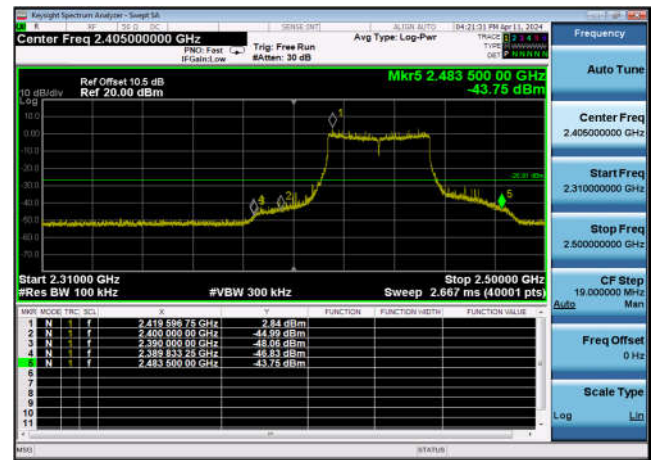
,Plot 2,Band Edge-802.11ax(40MHz) ,2437MHz,Ant12
