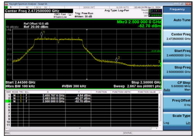
,Plot 3,30MHz~2400MHz-802.11n(20MHz) ,2412MHz,Ant12
