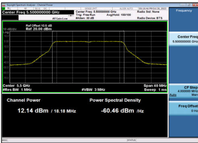
U-NII-2c Output Power-802.11n(20MHz) ,5580MHz,Ant9
