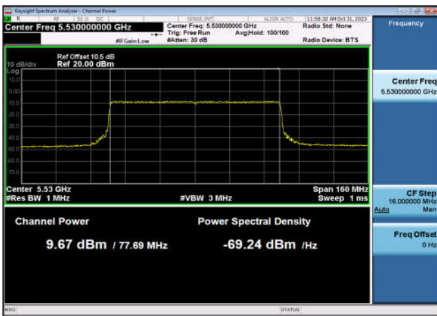
U-NII-3 Output Power-802.11n(20MHz) ,5745MHz,Ant9
