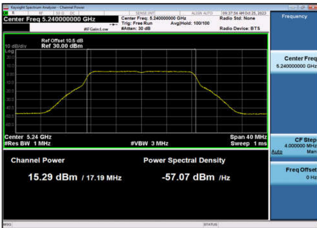
U-NII-1 Output Power-802.11ac(20MHz) ,5180MHz,Ant9
