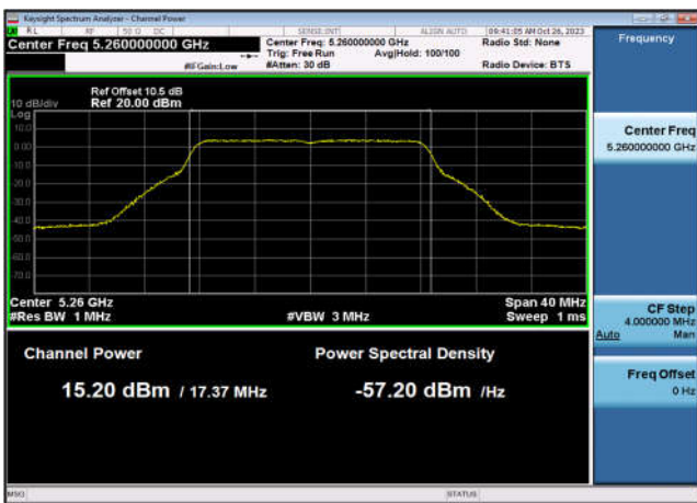
U-NII-2a Output Power-802.11a(20MHz) ,5300MHz,Ant9
