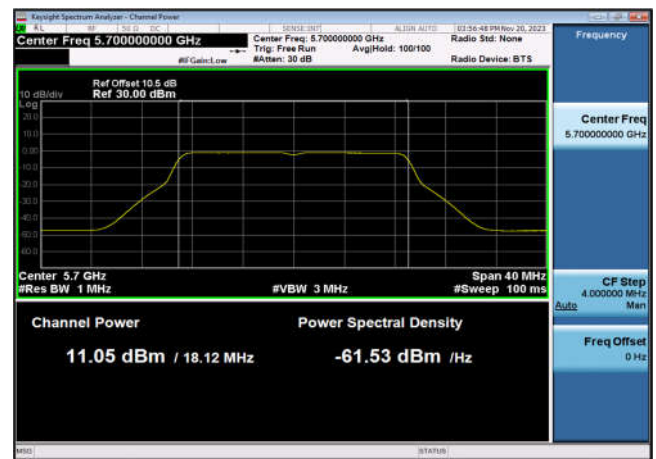
U-NII-2c Output Power-802.11ac(40MHz) ,5510MHz,Ant10
