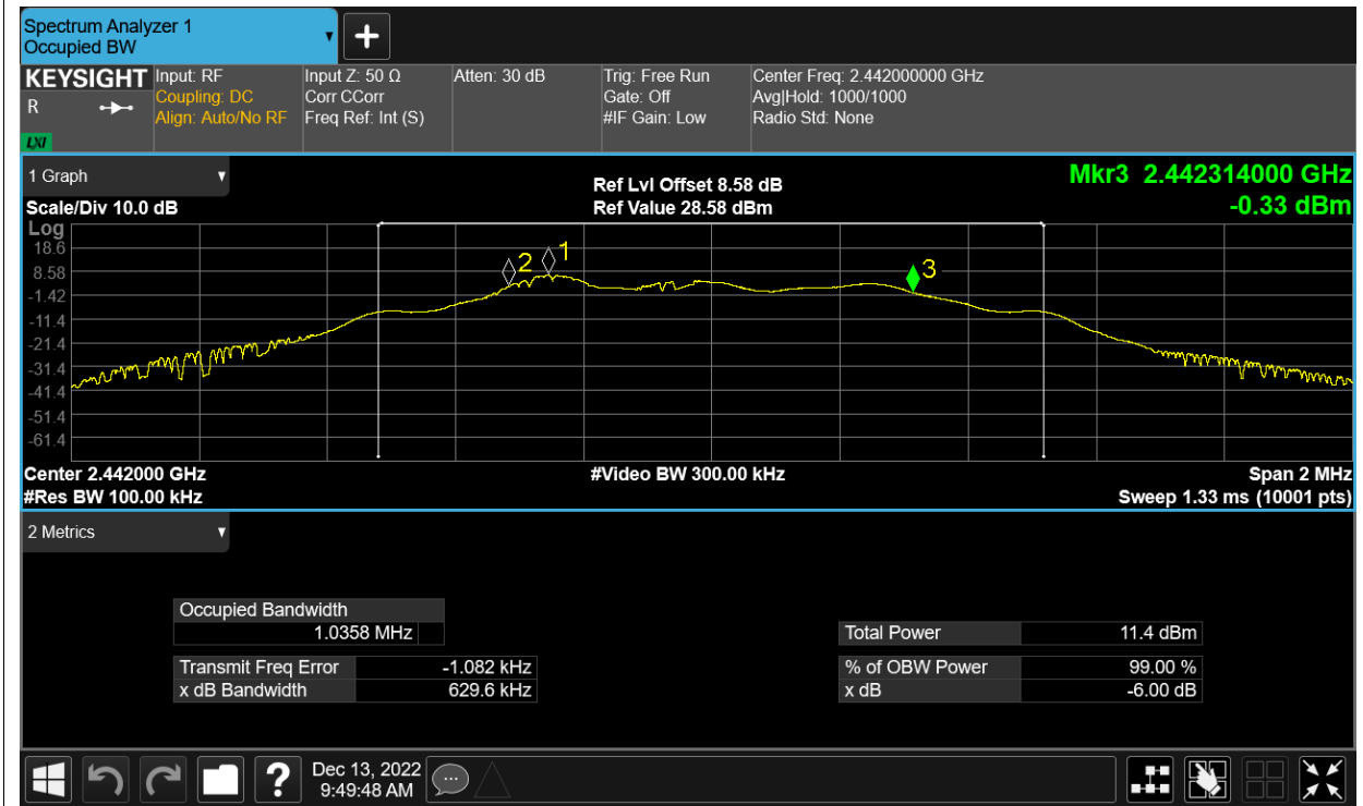
-6dB Bandwidth NVNT BLE 2480MHz Ant1
