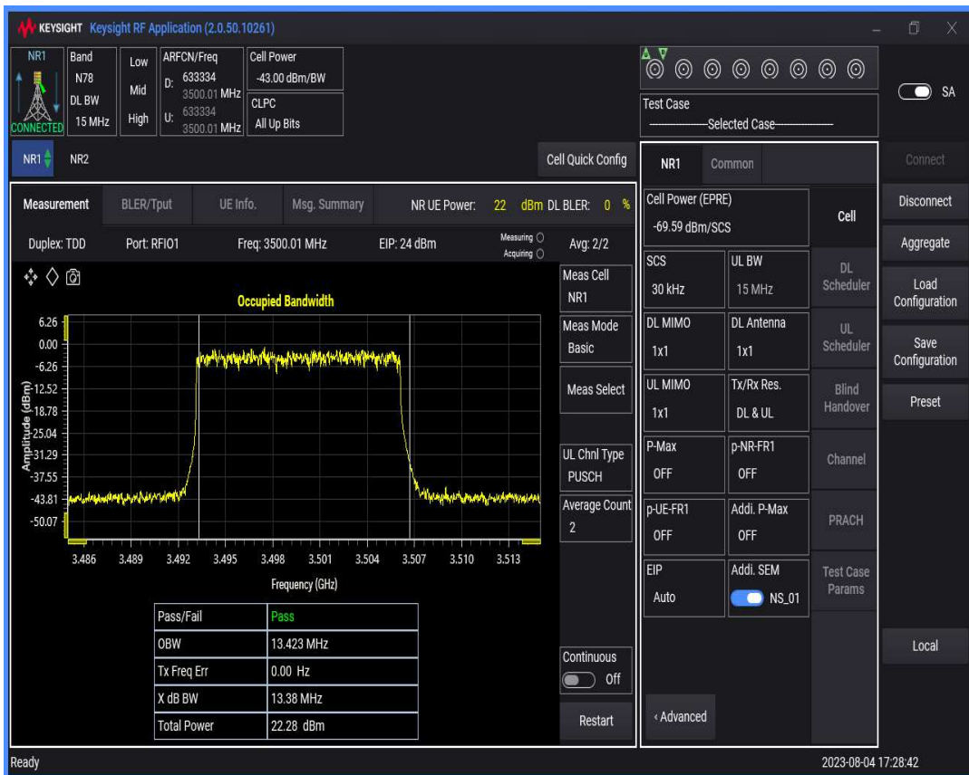
n78(3450-3550) SCS=30kHz DFT_QAM256 BW=20MHz Channel=633334 RB=50@0
