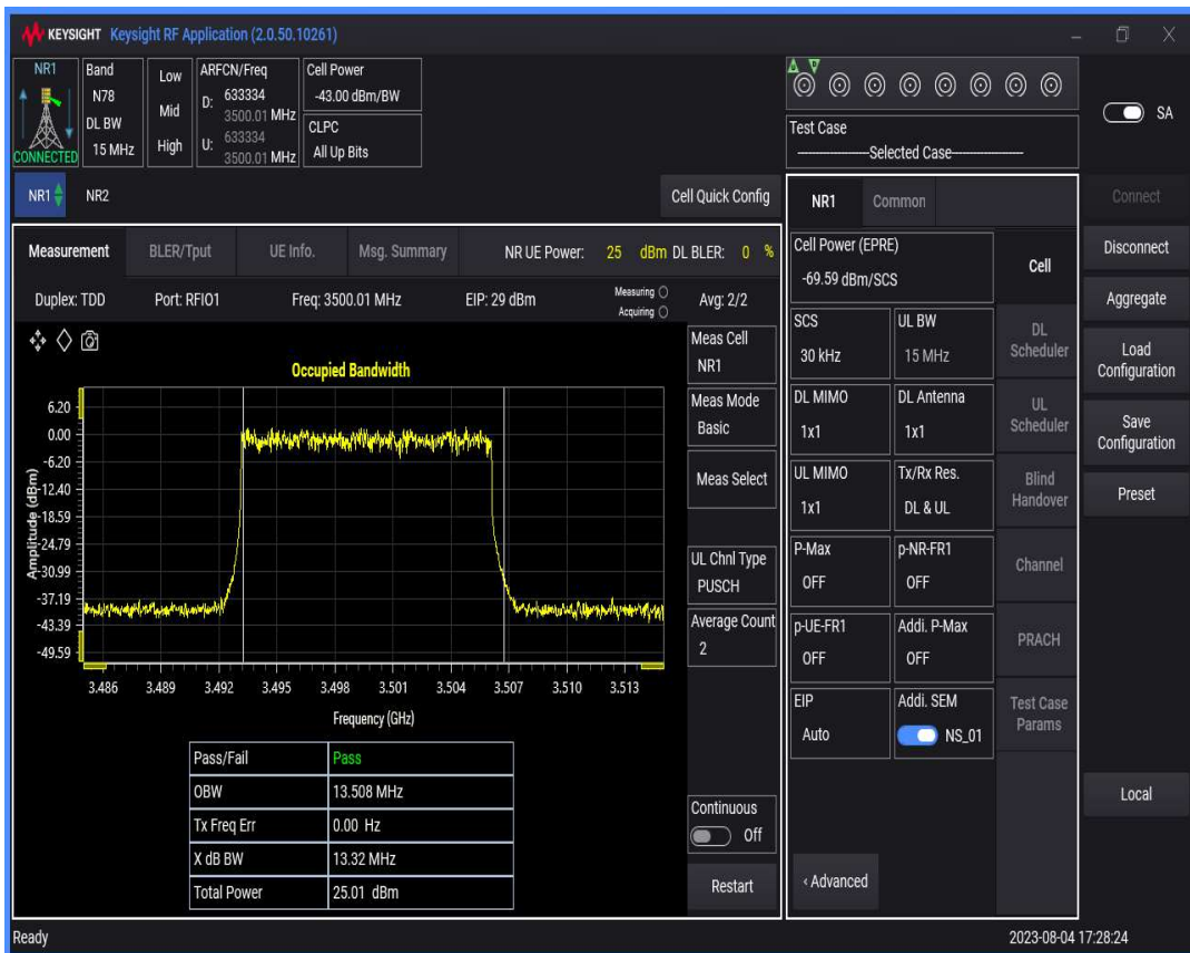
n78(3450-3550) SCS=30kHz DFT_BPSK BW=20MHz Channel=633334 RB=50@0
