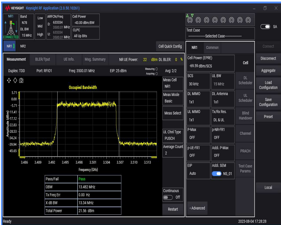
n78(3450-3550) SCS=30kHz DFT_QPSK BW=20MHz Channel=633334 RB=50@0
