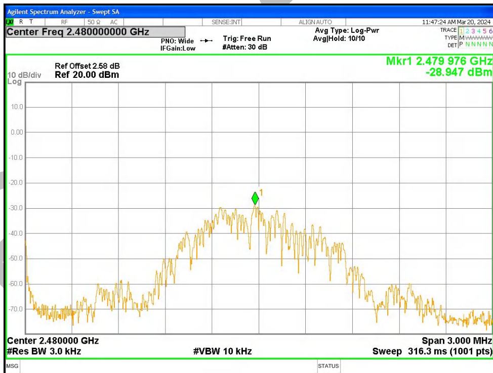
PSD NVNT BLE 2480MHz Ant1
