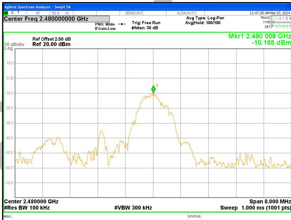
Band Edge NVNT BLE 2480MHz Ant1 Emission
