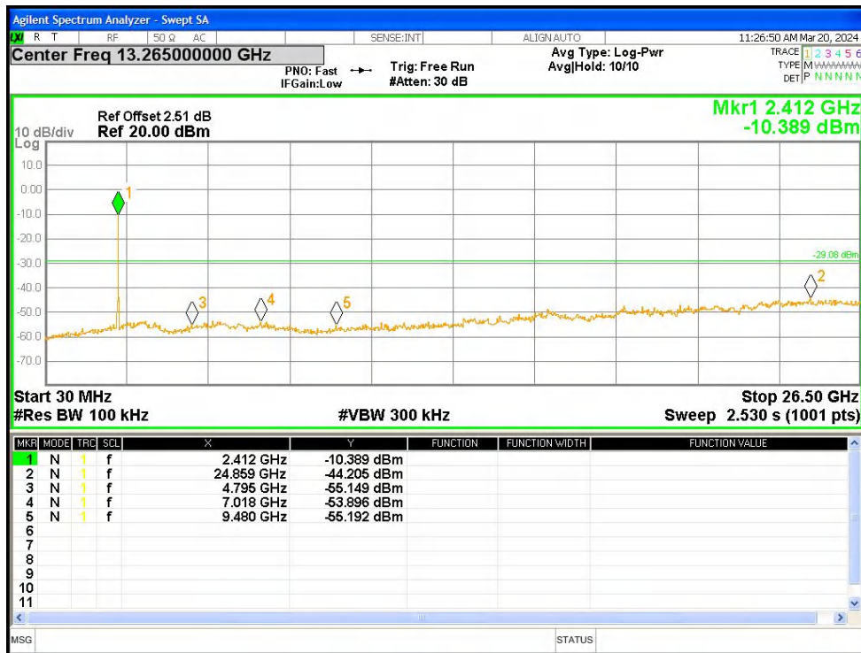
Tx. Spurious NVNT BLE 2442MHz Ant1 Ref
