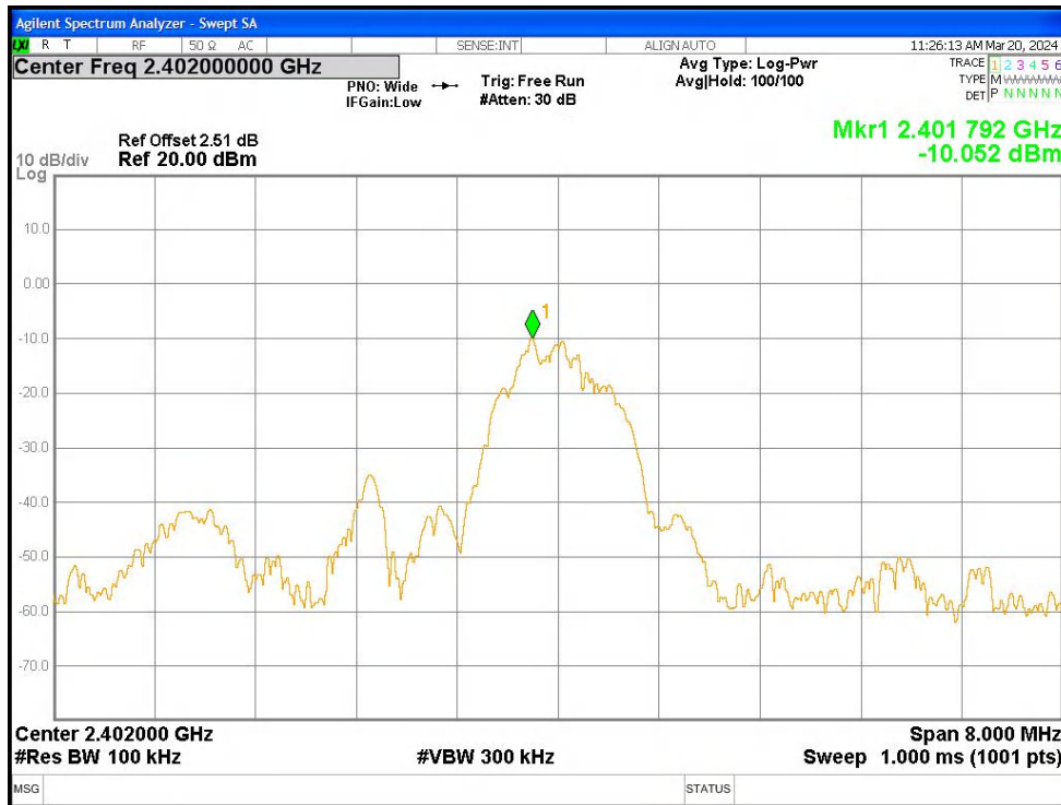
Band Edge NVNT BLE 2402MHz Ant1 Emission
