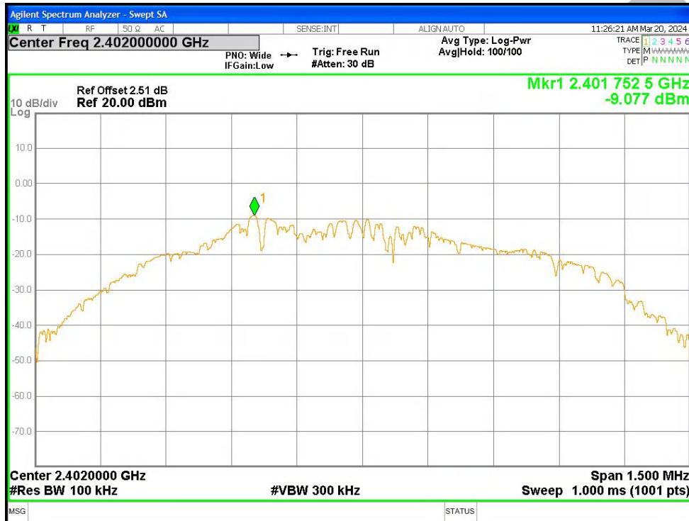
Tx. Spurious NVNT BLE 2402MHz Ant1 Emission
