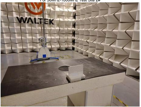
For 30MHz-1000MHz Test Site 2#
