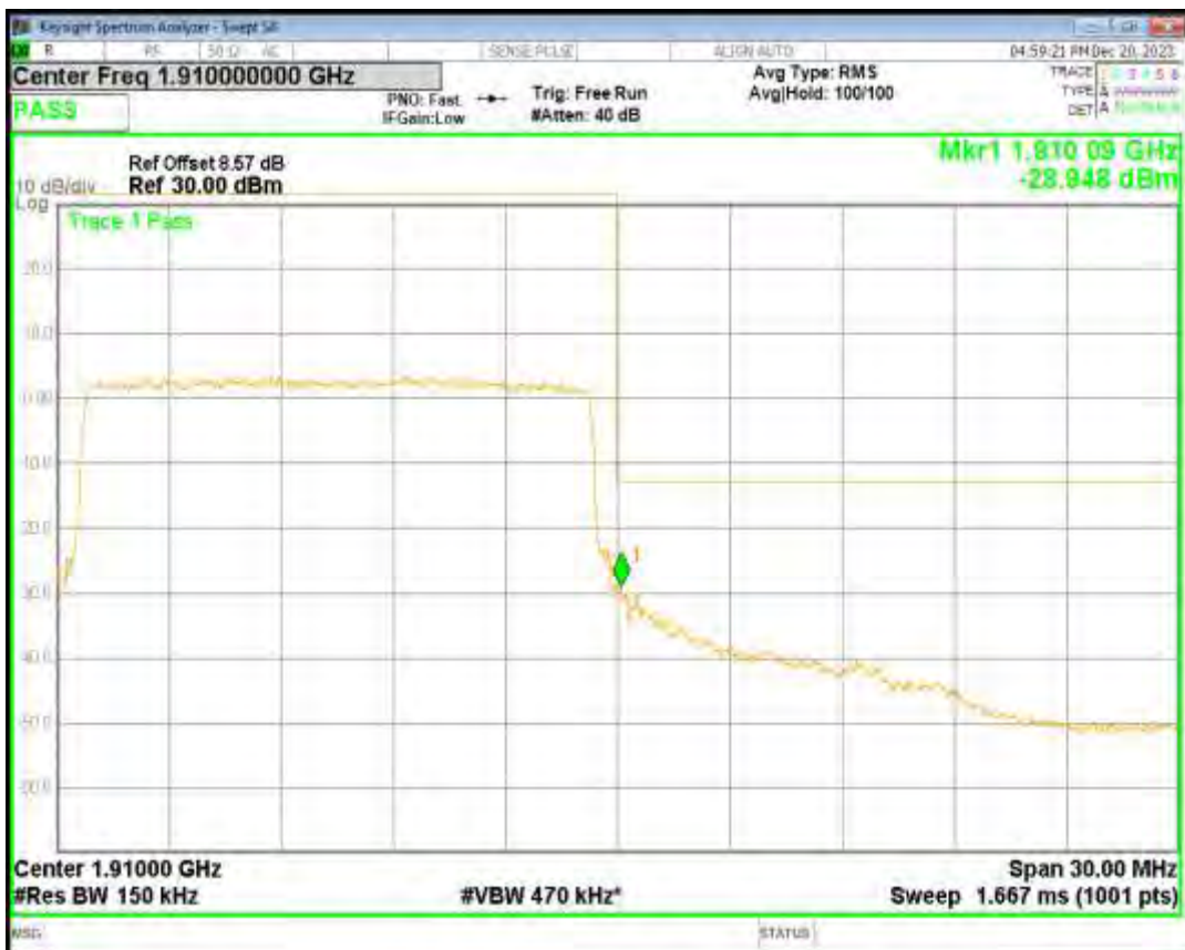
Band2 QPSK BW=20MHz Channel=18700 RB Size=100 Position=#0
