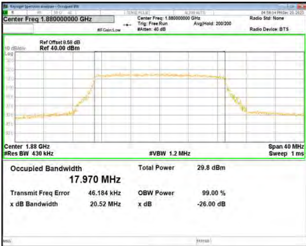
Band2 QPSK BW=20MHz Channel=19100 RB Size=100 Position=#0
