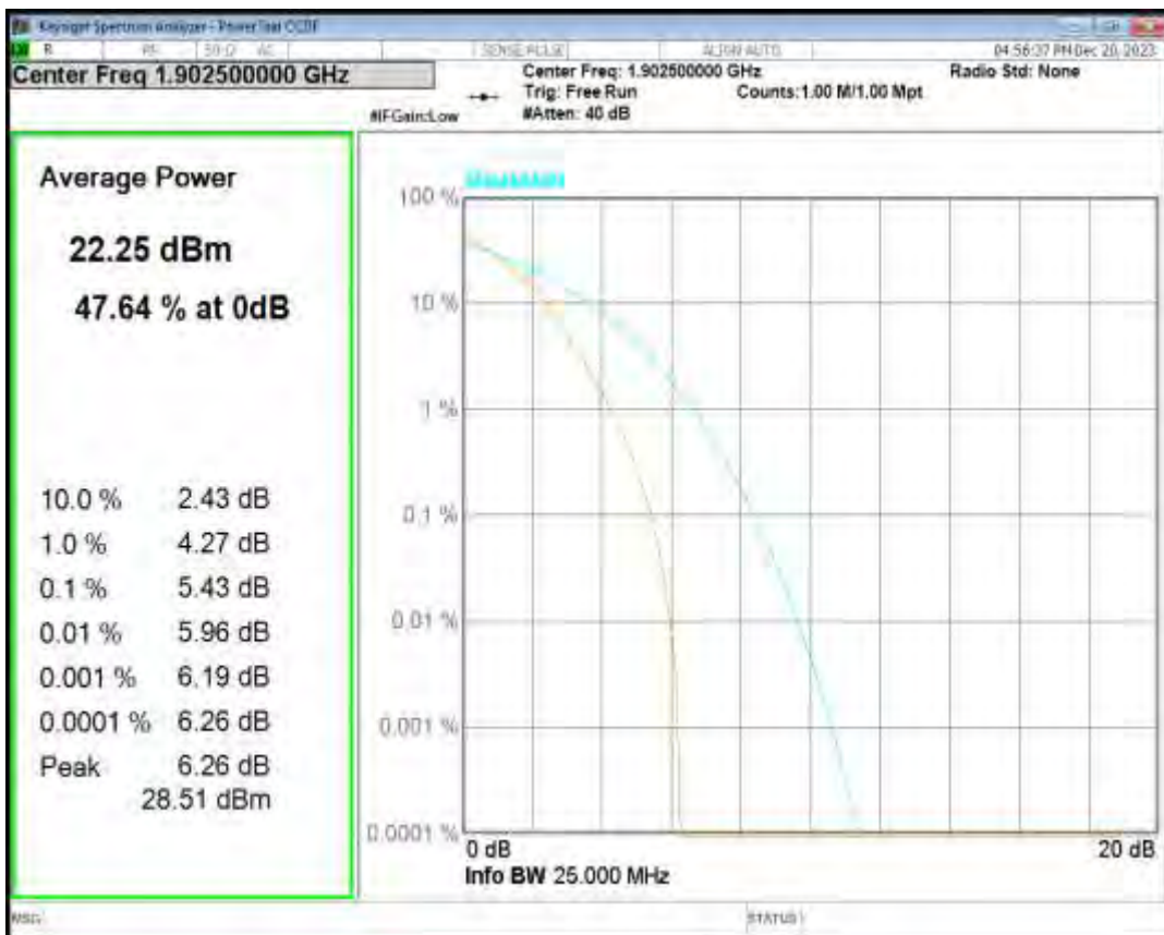
Band2 QPSK BW=20MHz Channel=18700 RB Size=1 Position=#0
