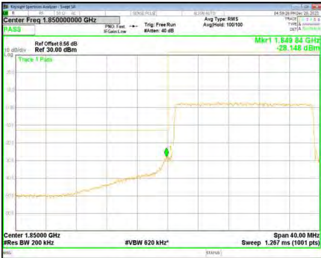
Band2 QPSK BW=20MHz Channel=19100 RB Size=100 Position=#0
