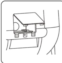
④. 本機のバックカバーで、2つのクリップを上に押し、バックカバーを外側に持ち上げて取り外します。
