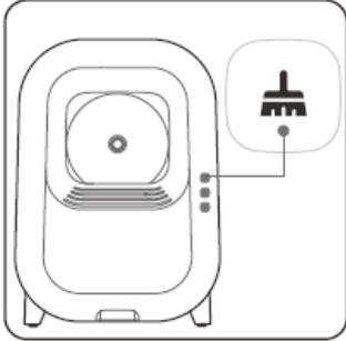
① Mantenga pulsado el botón de limpieza durante 3 segundos, sonará un pitido y se activará la función de vaciado del arenero.
