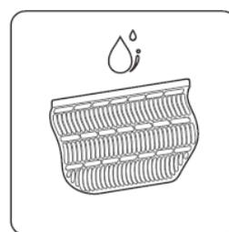
⑦ Nettoyez la crépine séparément avec de l'eau et laissez-la sécher avant de la réinstaller.
