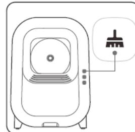
④ Vuelva a colocar la tapa superior en el arenero. Haga doble clic rápidamente en el botón de limpieza para calibrar el peso del arenero para gatos. Una vez finalizada la calibración del peso, sonarán tres pitidos.
