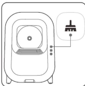
⑤ Remplacez le couvercle sur le bac à litière. Double-cliquez rapidement sur le bouton de nettoyage pour calibrer le poids de la litière. Une fois le calibrage du poids terminé, l'avertisseur sonore retentit trois fois.
