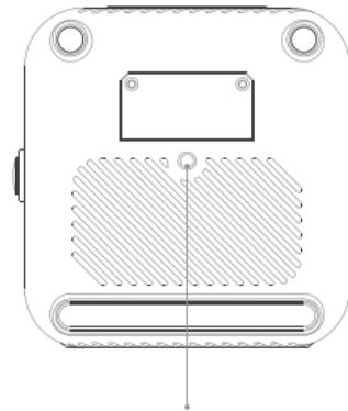
Bitte stellen Sie sicher, dass Sie im Deckenmodus 1/4 " Schrauben verwenden.
