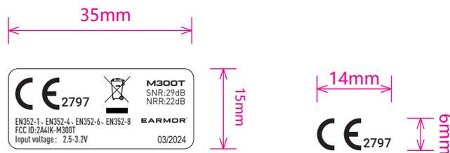
不干胶贴纸需过高低湿温可靠性测试，测试后，不脱落不掉色
