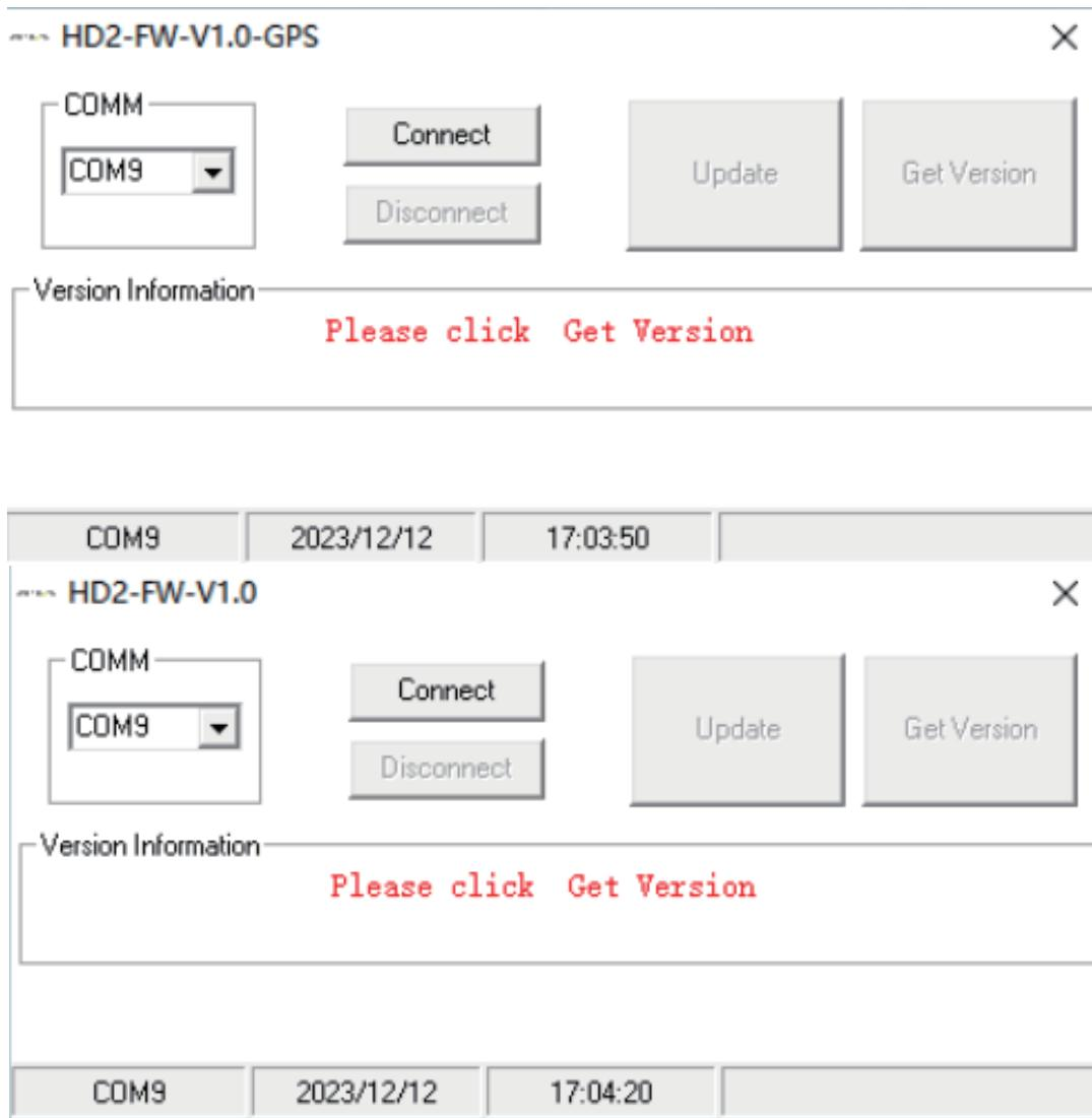
3) Conecte el cable de programación a la computadora y luego elija el puerto de comunicación del dispositivo correcto. Haga clic en Conectar y luego en Actualizar. mostrará la barra de progreso de actualización.
