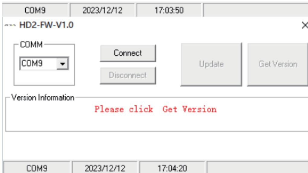
3)Connectez le câble de programmation à l'ordinateur, puis choisissez le bon port COM de l'appareil, cliquez sur Connecter, puis sur Mettre à jour. il affichera la barre de progression de la mise à niveau.
