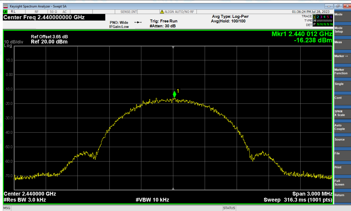
PSD NVNT BLE 1Mbps 2440MHz Ant1
