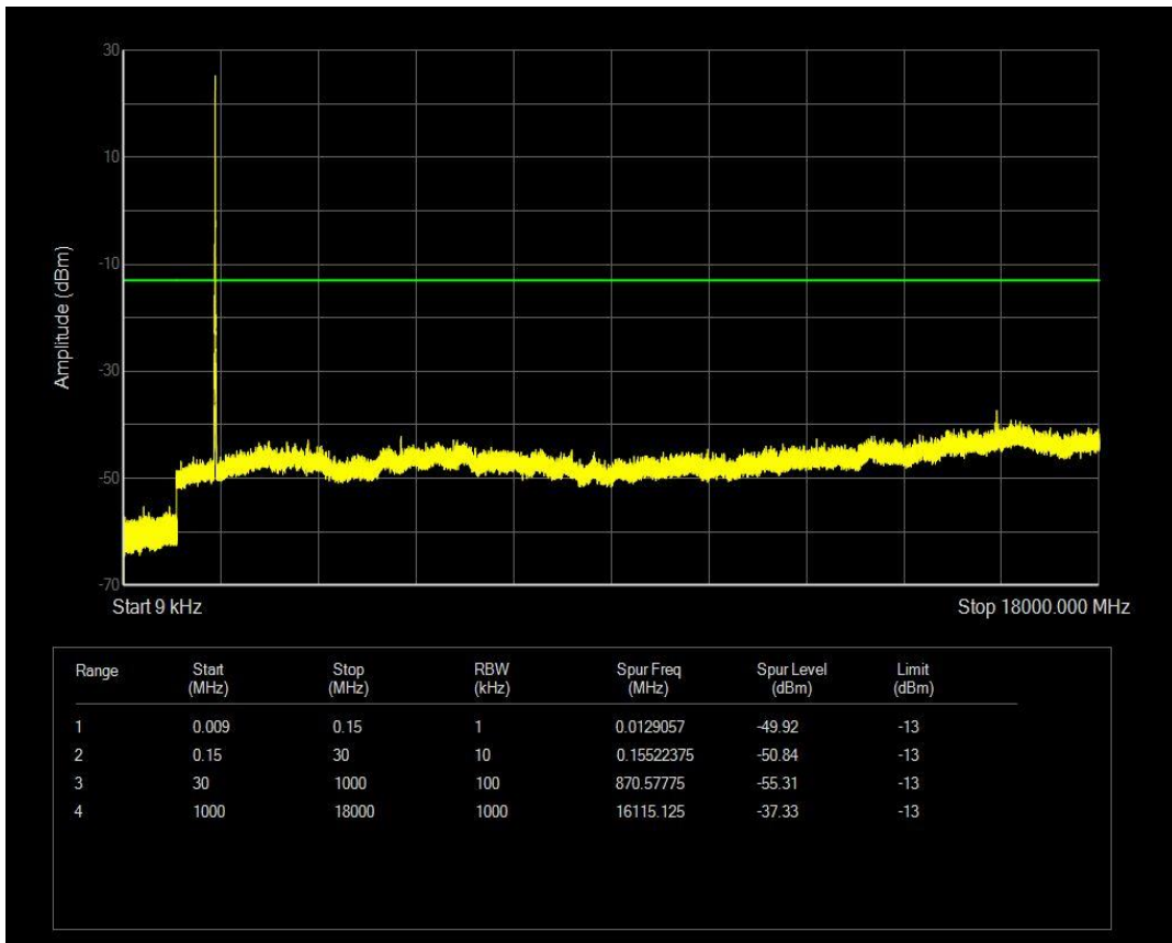
n66 SCS=15kHz CP_QPSK BW=5MHz Channel=355500 RB=1@0
