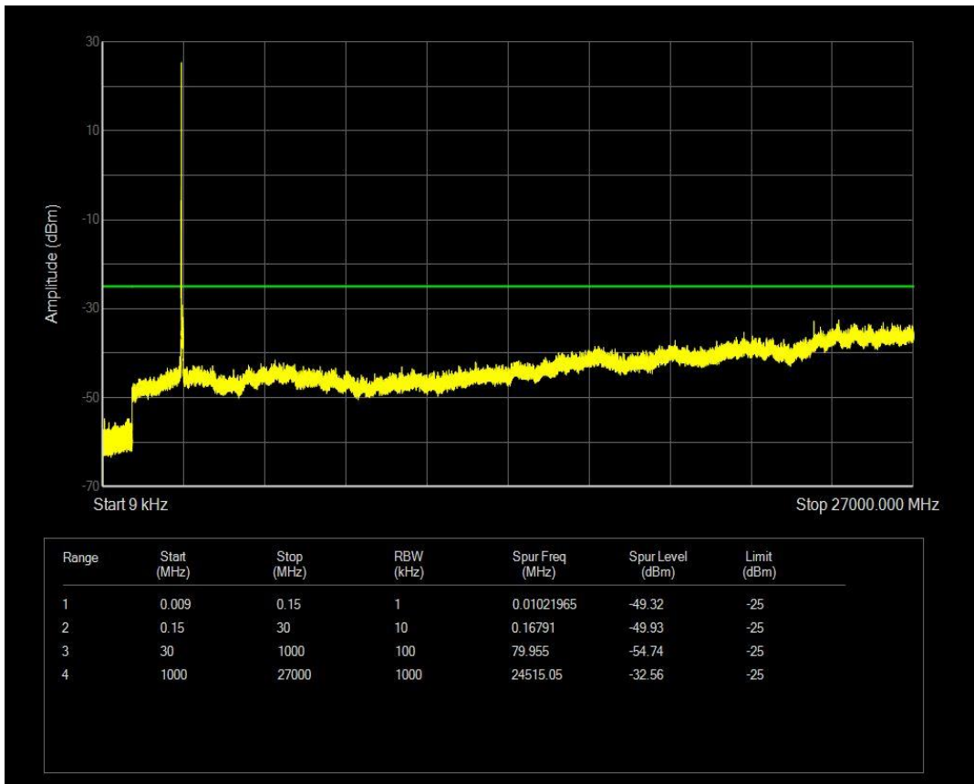
n41 SCS=30kHz CP_QPSK BW=50MHz Channel=532998 RB=1 @132
