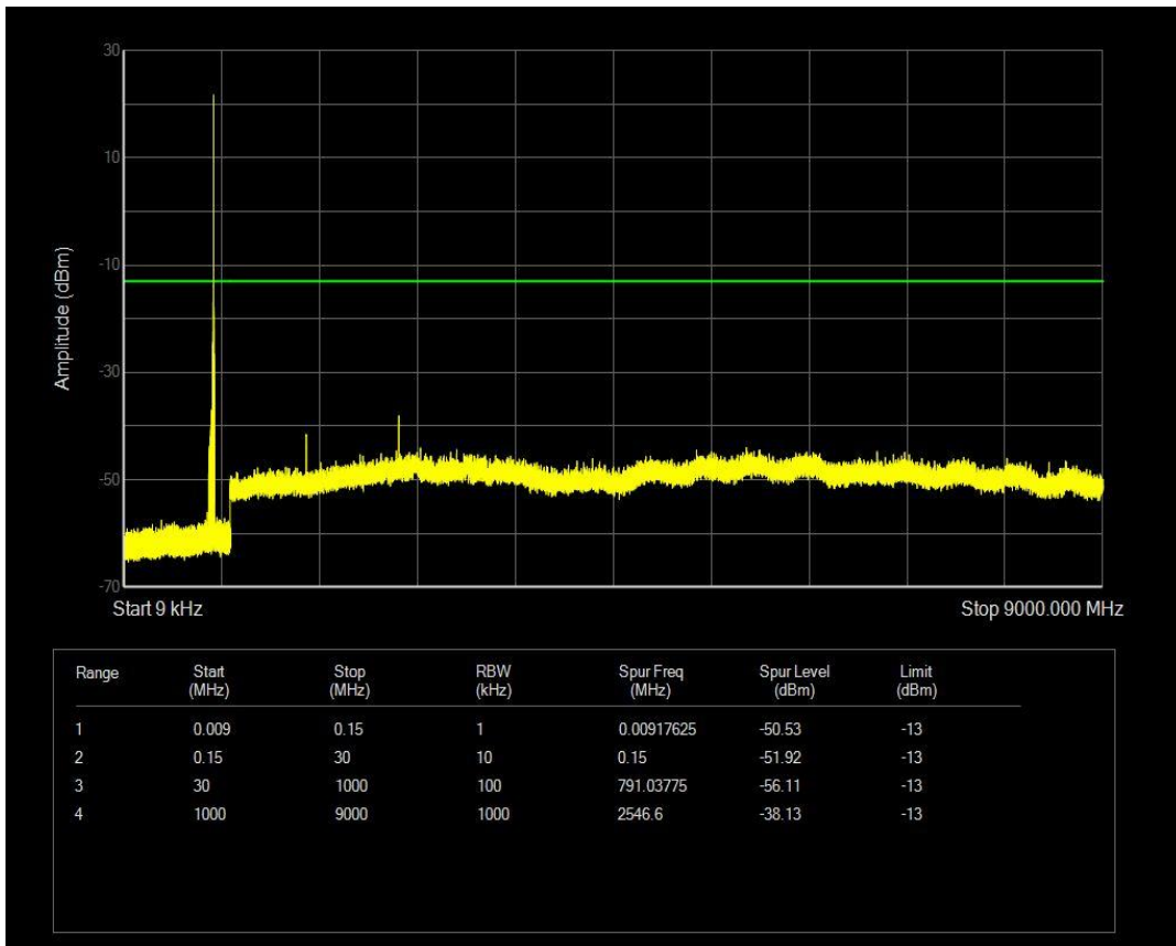
n5 SCS=15kHz CP_QPSK BW=5MHz Channel=169300 RB=25@0
