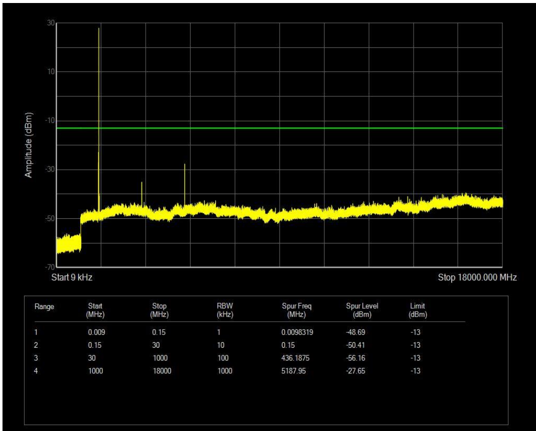
n66 SCS=15kHz CP_QPSK BW=20MHz Channel=354000 RB=106@0
