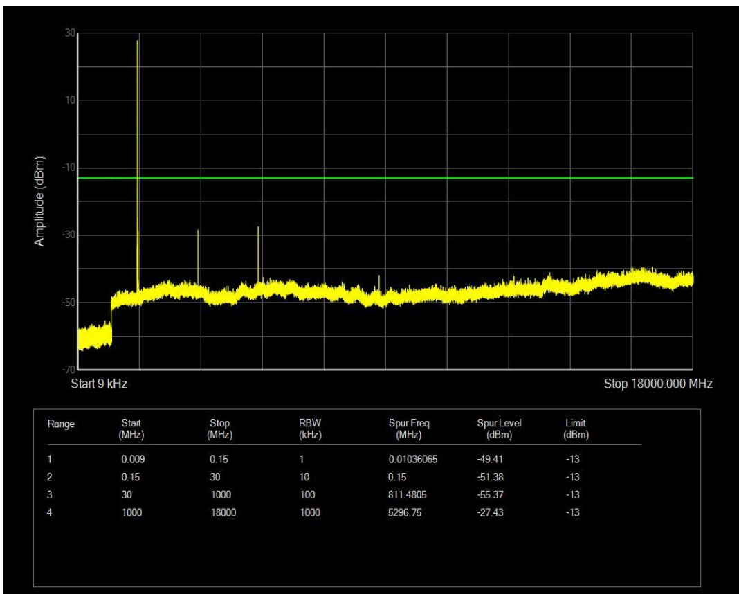
n66 SCS=15kHz CP_QPSK BW=15MHz Channel=354500 RB=1@78
