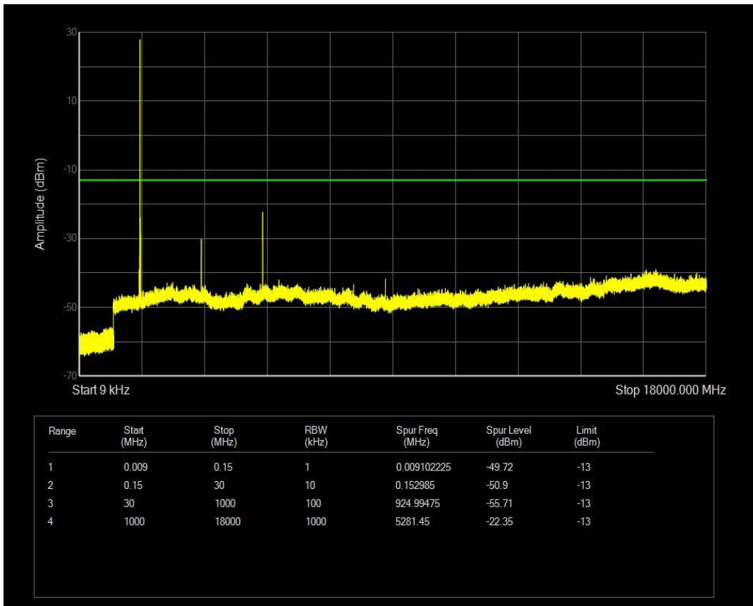
n66 SCS=15kHz CP_QPSK BW=20MHz Channel=354000 RB=1 @105
