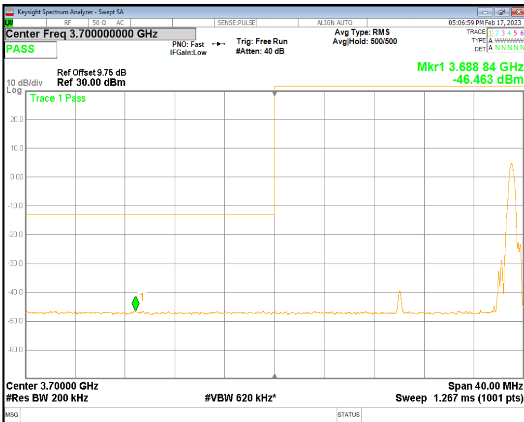
n78(3700-3800) SCS=30kHz CP QPSK BW=20MHz Channel=652666 RB=51@0
