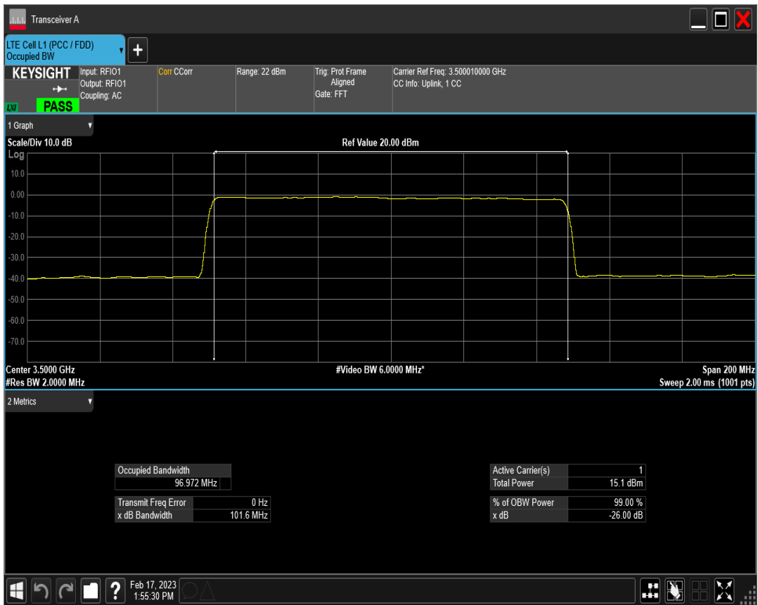
n78(3700-3800) SCS=30kHz DFT BPSK BW=20MHz Channel=650000 RB=50@0
