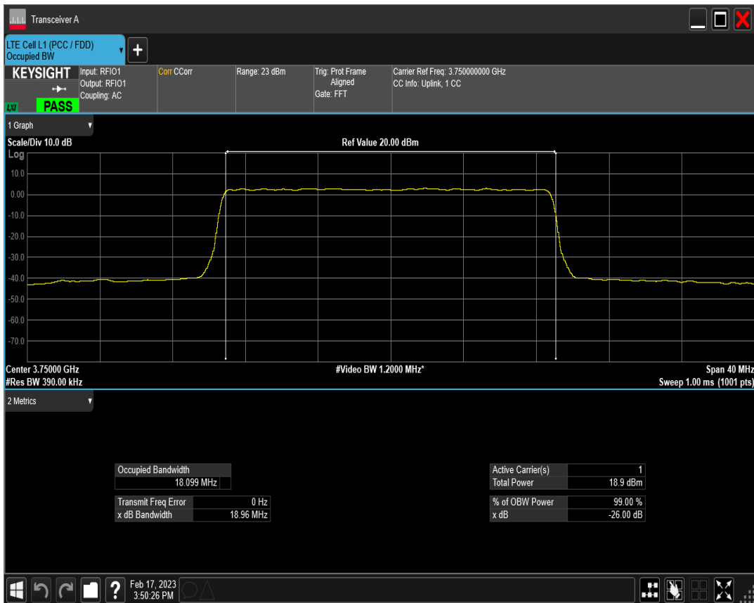
n78(3700-3800) SCS=30kHz DFT 16QAM BW=20MHz Channel=650000 RB=50@0
