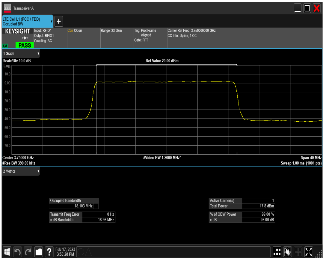
n78(3700-3800) SCS=30kHz DFT 64QAM BW=20MHz Channel=650000 RB=50@0
