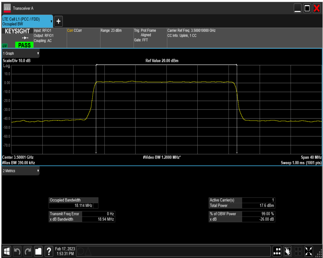
n78(3450-3550) SCS=30kHz DFT 64QAM BW=20MHz Channel=633334 RB=50@0
