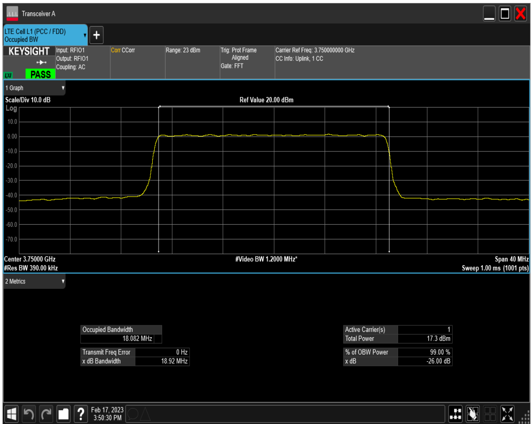
n78(3700-3800) SCS=30kHz DFT 256QAM BW=20MHz Channel=650000 RB=50@0
