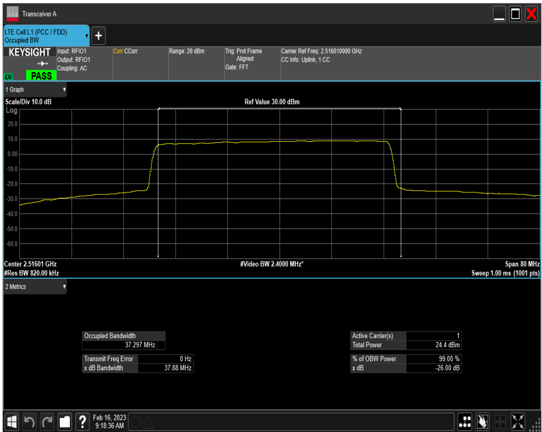
n41 SCS=30kHz DFT_QPSK BW=40MHz Channel=518598 RB=100@0
