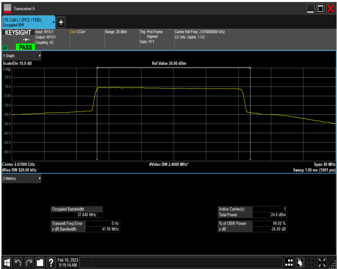
n41 SCS=30kHz DFT_QPSK BW=50MHz Channel=504204 RB=128@0
