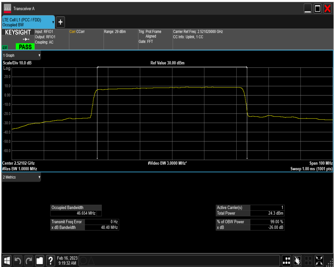
n41 SCS=30kHz DFT_QPSK BW=50MHz Channel=518598 RB=128@0
