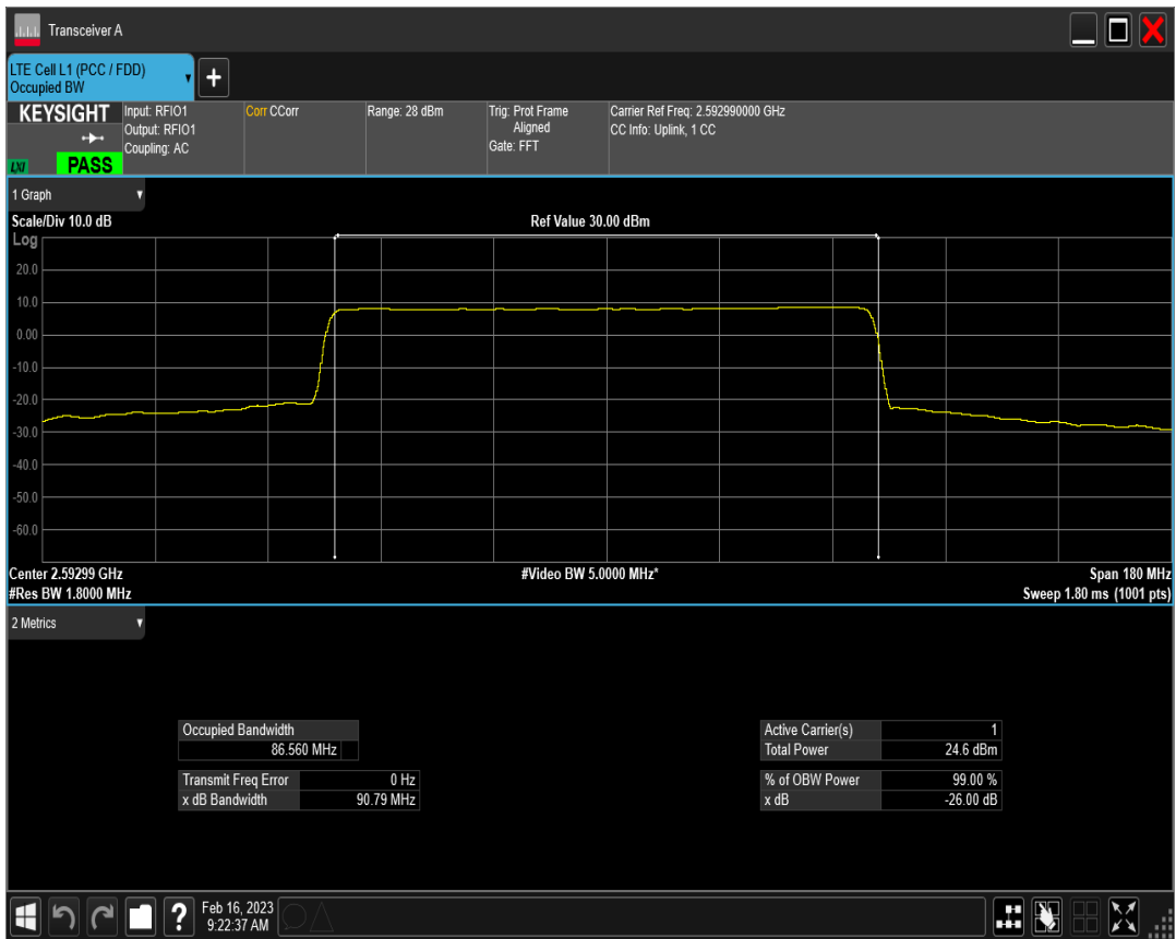
n41 SCS=30kHz DFT_QPSK BW=90MHz Channel=528996 RB=240@0
