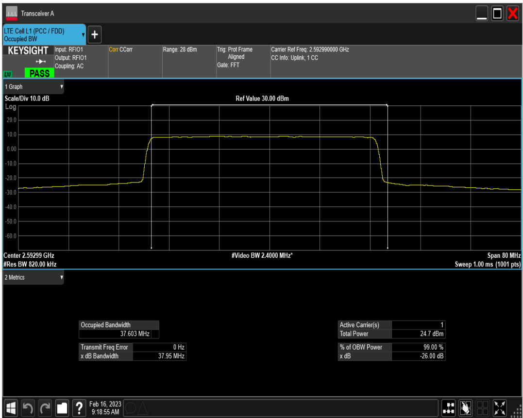
n41 SCS=30kHz DFT_QPSK BW=40MHz Channel=534000 RB=100@0
