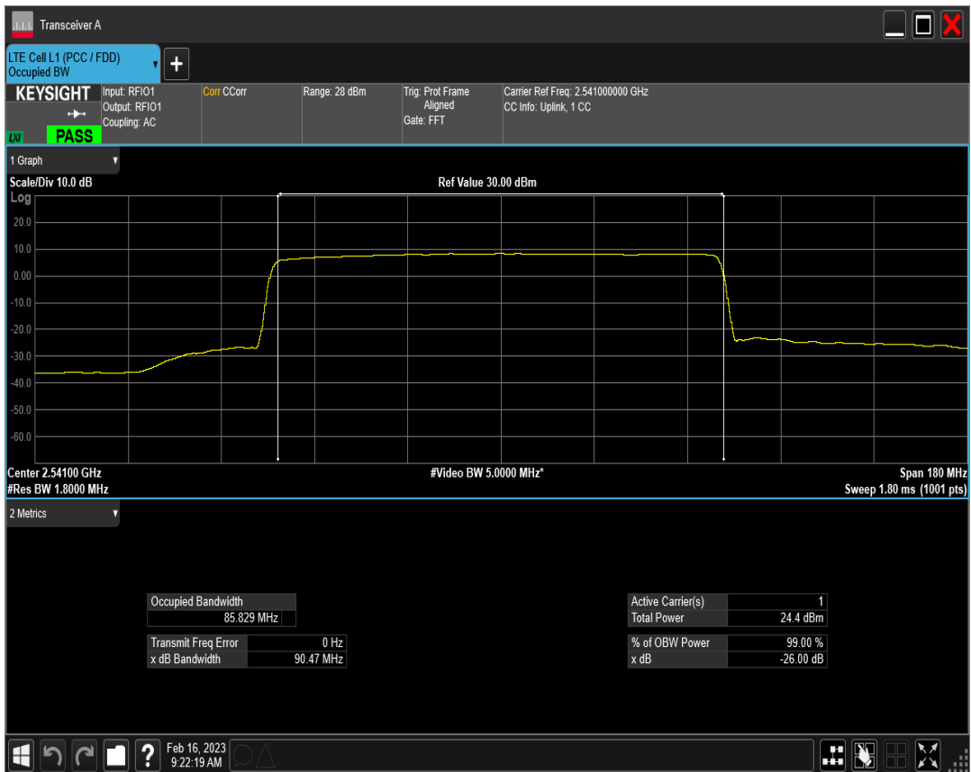
n41 SCS=30kHz DFT_QPSK BW=90MHz Channel=518598 RB=240@0
