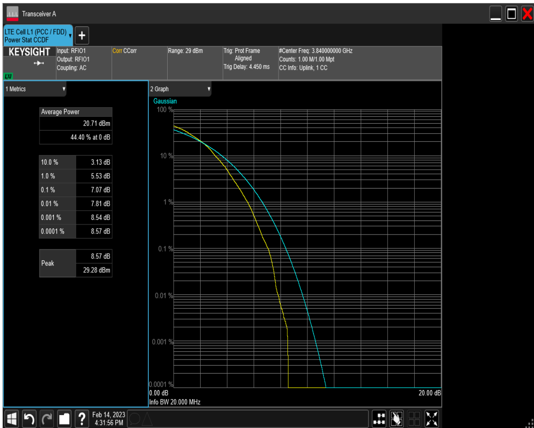
n77(3700-3980) SCS=30kHz DFT_QAM64 BW=20MHz Channel=664666 RB=50@0
