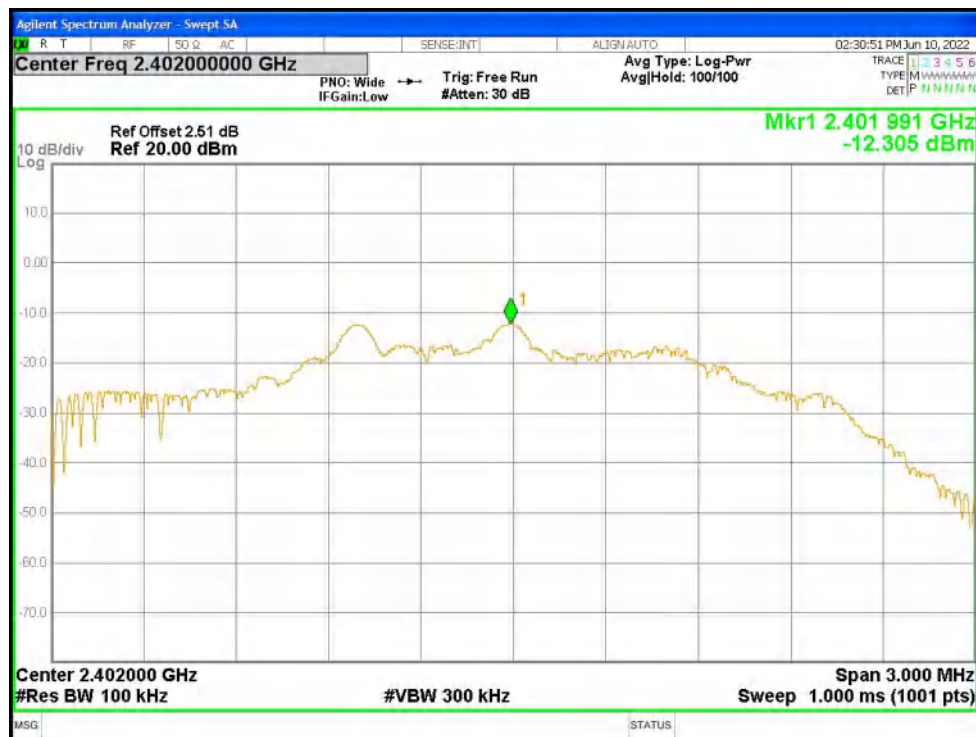
PSD NVNT BLE 2M 2442MHz Ant1
