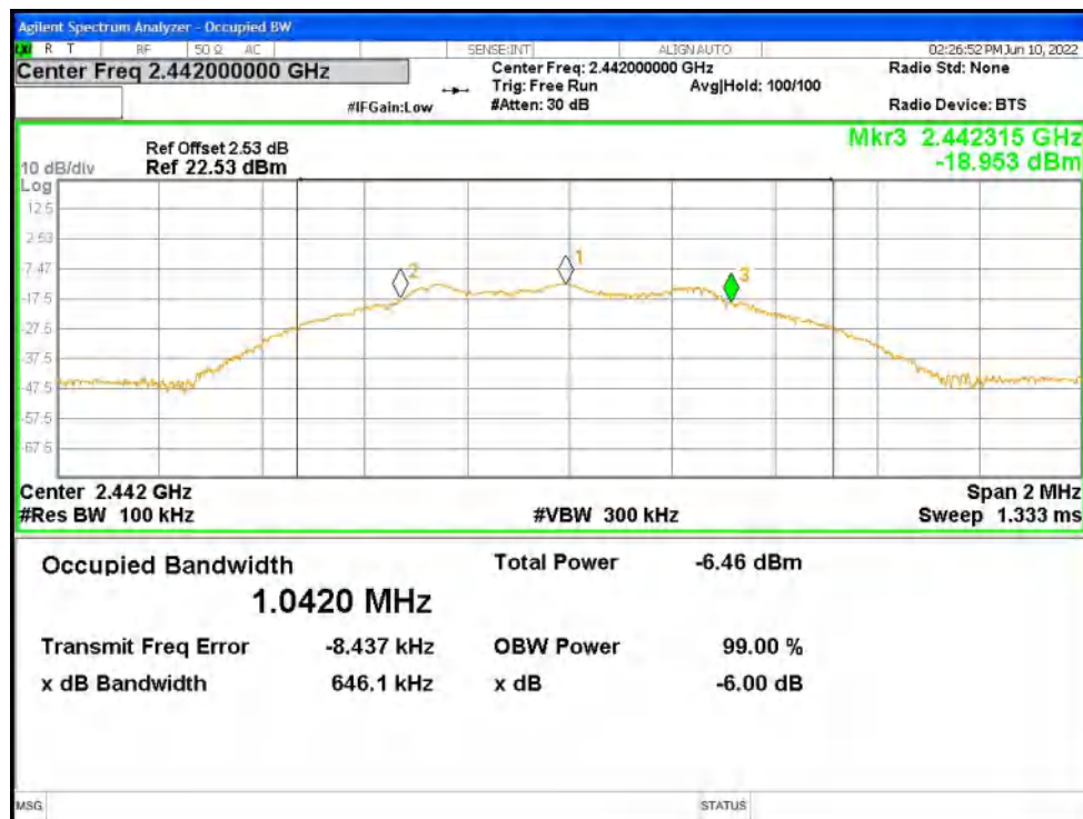
-6dB Bandwidth NVNT BLE 1M 2480MHz Ant1
