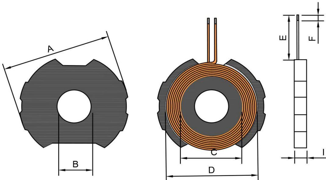
备注 Note: 1.磁片铁氧体软磁材质; 2.无磁铁
