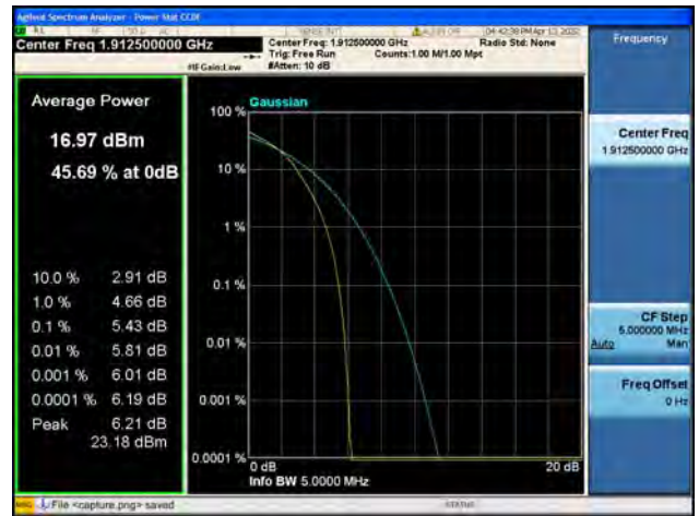
Band25 / 10MHz / Low CH / QPSK
