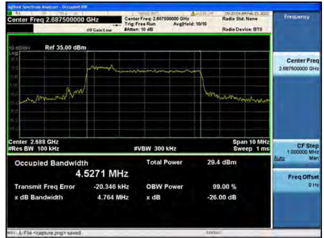
Band41 / 10MHz / Low CH / QPSK
