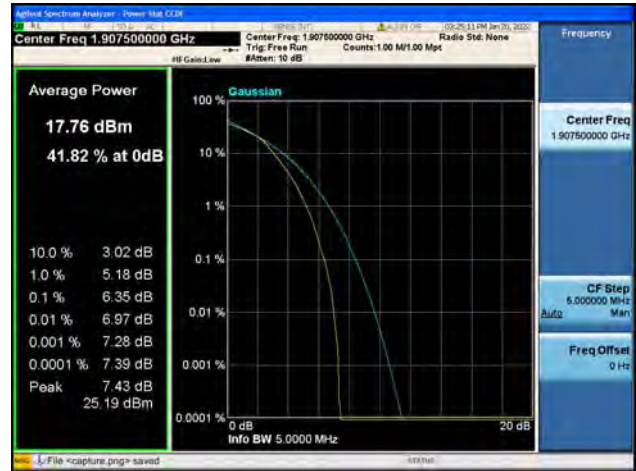
Band2 / 10MHz / Low CH / QPSK
