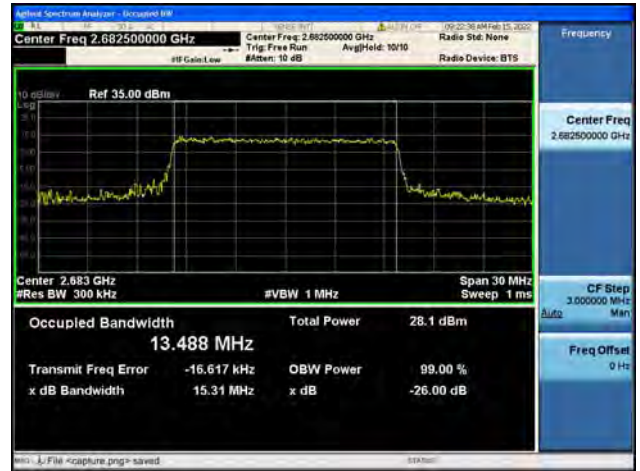
Band41 / 20MHz / Low CH / QPSK
