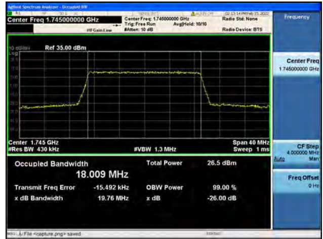
Band66 / 20MHz / High CH / QPSK
