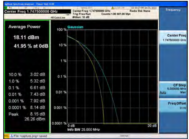
Band4 / 20MHz / Low CH / QPSK
