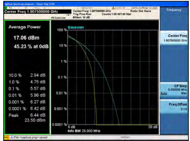
Band25 / 20MHz / Low CH / QPSK
