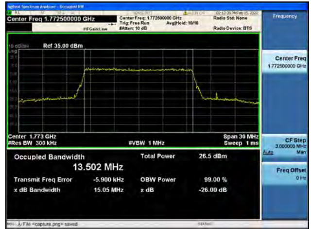
Band66 / 20MHz / Low CH / QPSK
