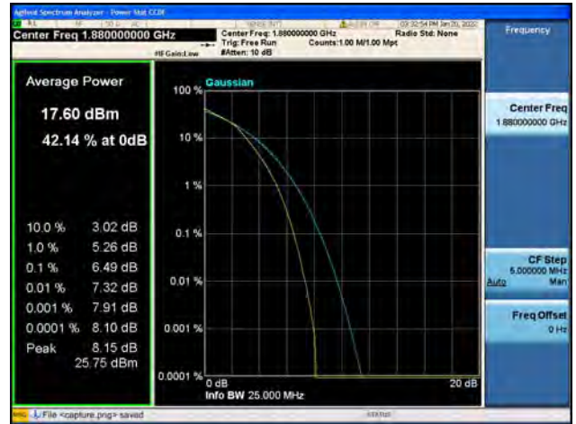
Band2 / 20MHz / High CH / QPSK
