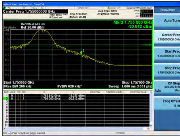
Band4 / 20MHz / High CH / QPSK / 1 RB
