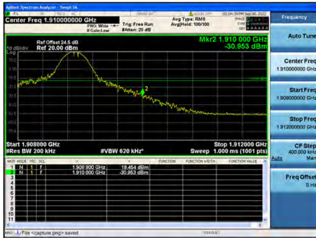
Band2 / 20MHz / High CH / QPSK / 1 RB
