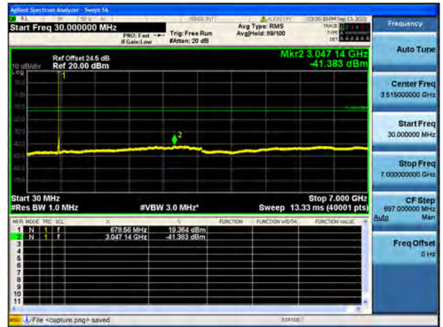
Band71 / 5MHz / High CH / 16QAM
